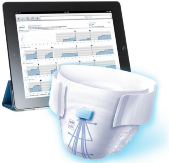
Kuva 1. TENA Identifi -arviointijärjestelmä (TENA)
