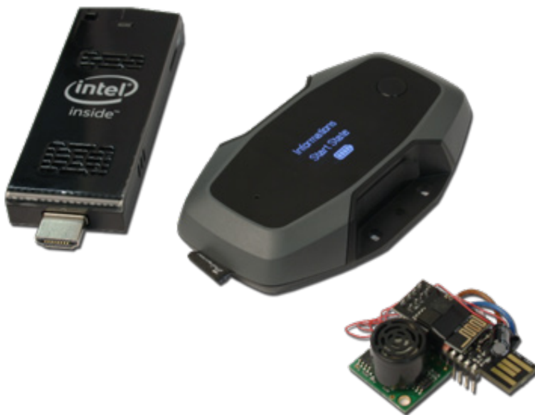
Kuva 18. Sovellettavuustestauksessa käytetyt Intel Compute Stick, Thingsee one sekä Espruino Pico.
