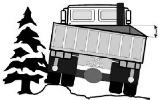
Kuvio 16. Kuorma-autonrungon vääntöjoustavuus. (SISU. 2010, 2).
