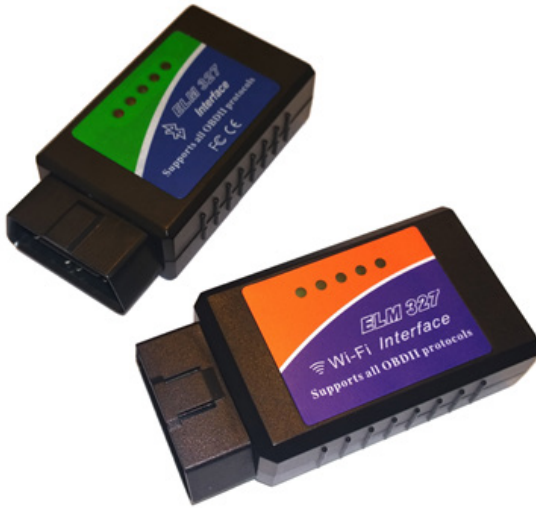
Kuva 10. Testaamiseen käytettyjä ELM 327 OBD2-lukijoita, WLAN- ja Bluetooth-versiot.
