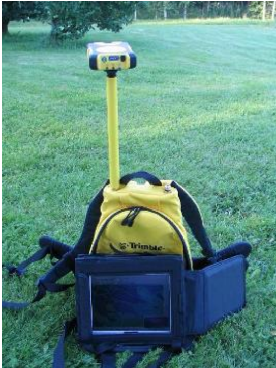
Kuva 3. Trimble GPS -paikanninreppu (Hällfors, 2008.)
