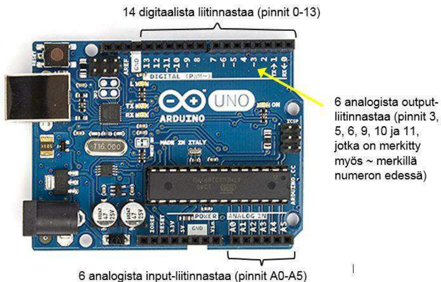
KUVA 7. Arduino Uno R3 - piirilevy liittinnastoinen (Arduinon kotisivut 2015, muokattu)
