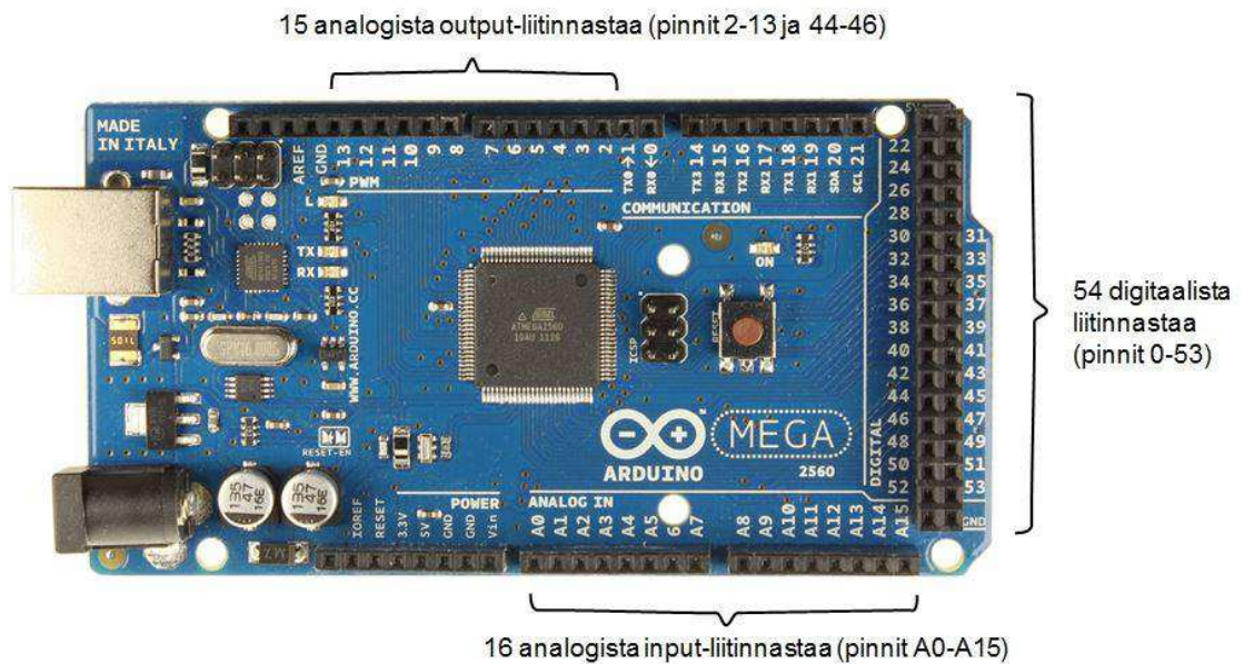
KUVA 8. Arduino Mega 2560 R3 - piirilevy liittinnastoineen (Arduinon kotisivut 2015, muokattu)
