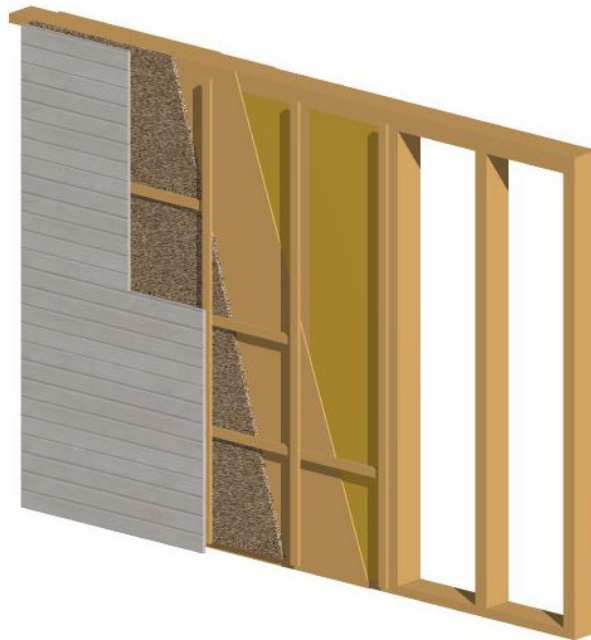
Kuva 13 Seinärakenteen leikkaus ulkopuolelta
