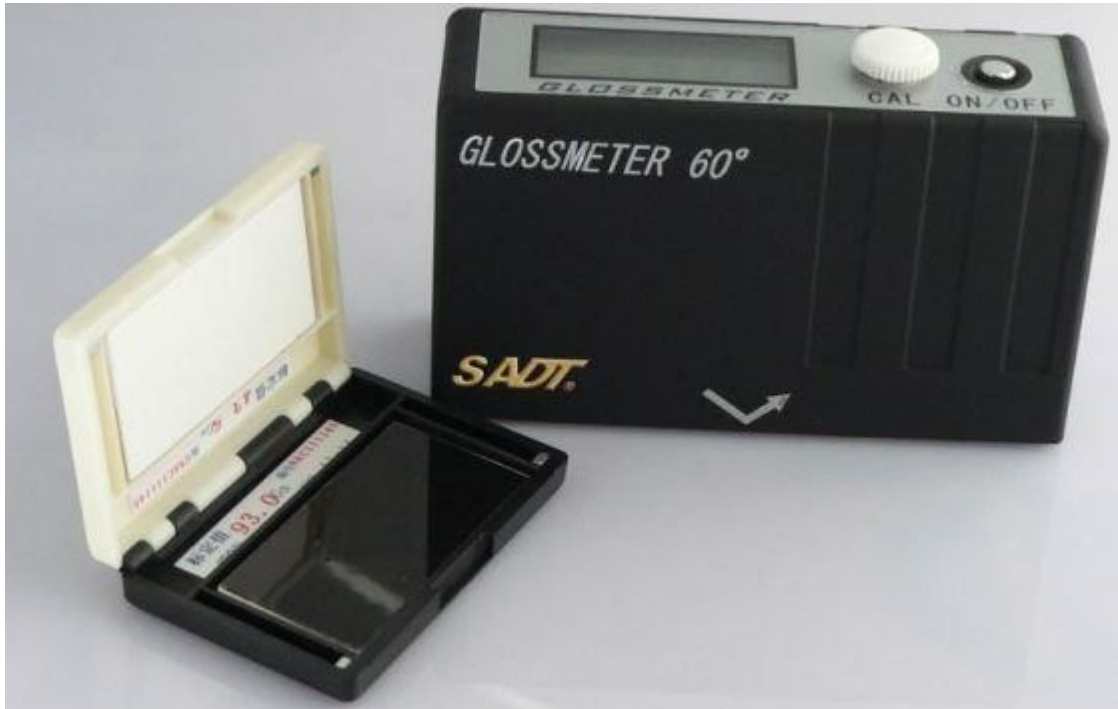
Kuva 45. Kyseillä mittarilla mitataan maalipinnan kiiltoa. [16]
