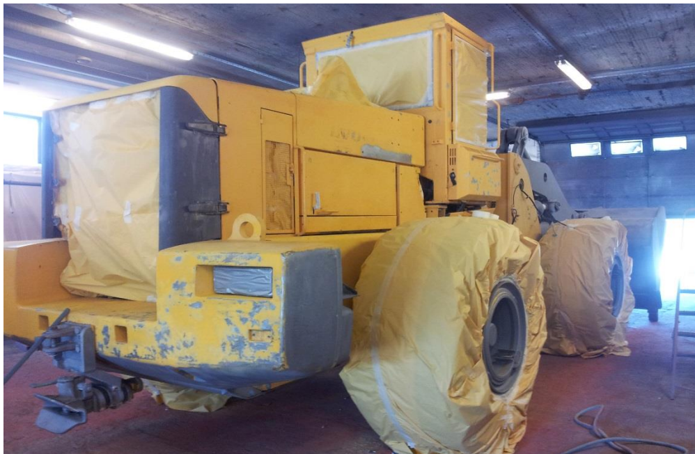
Kuva 23. Maalattavana oleva pyöräkone, jolle esikäsitteily ja pohjamaalaus on tehty samassa tilassa.
