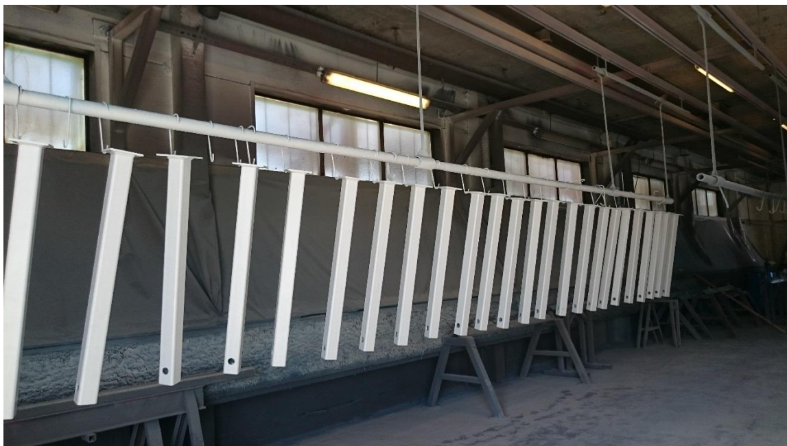
Kuva 22. Kuivuvia maalattuja kappaleita nykyisellä kiskokuljettimella.
