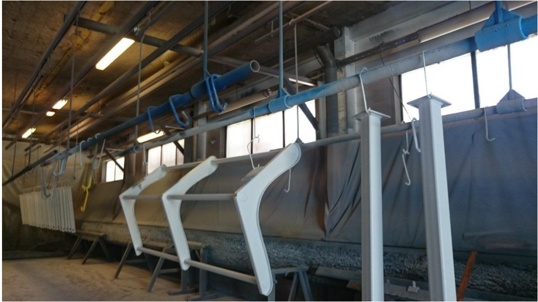
Kuva 43. Kuvassa olevilla kiskoilla maalattavien kappaleiden liikuttelu onnistuu vain hallin pitkittäissuunnassa.
