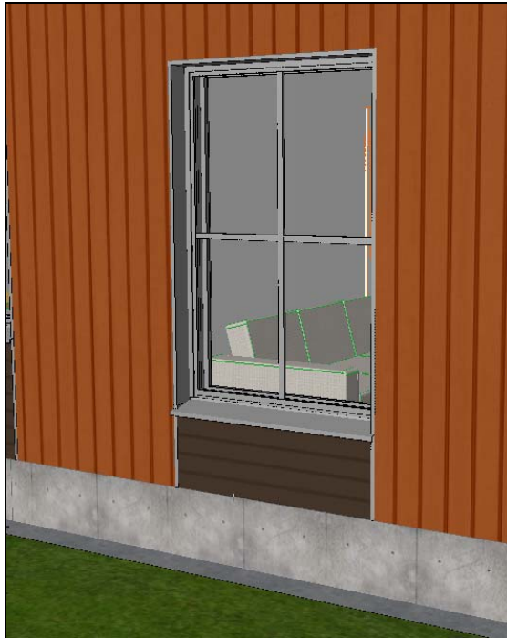
Kuva 10. Seinäpintaelementin käyttö, 3D.
