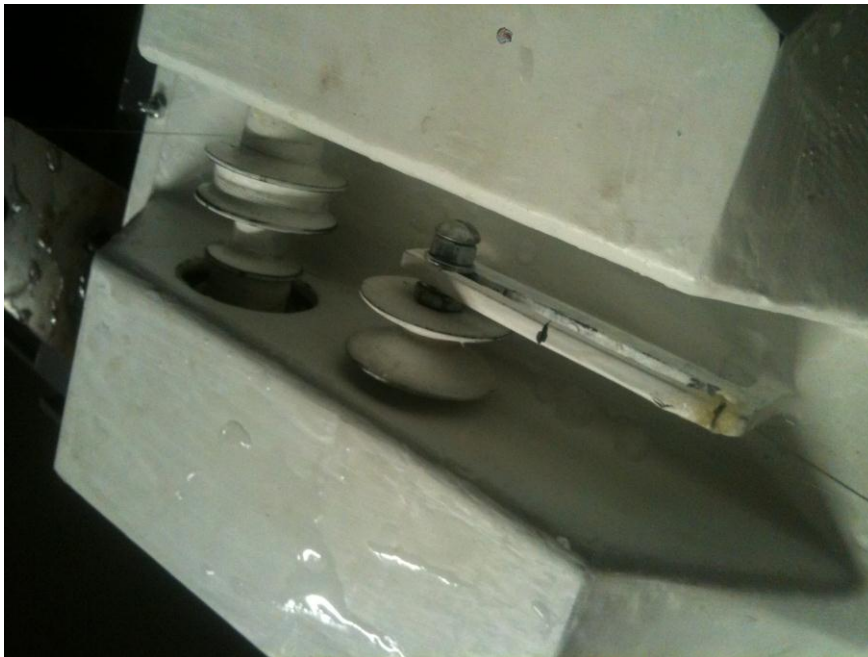
KUVA 15. Juoksupyörä kiskolla mahdollisimman lähellä akselia (Konsta Kilponen 2015)
