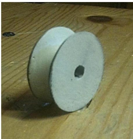
KUVA 5. Epoksimaalilla maalattu pikamallinnettu juoksupyörä (Konsta Kilponen 2015)
