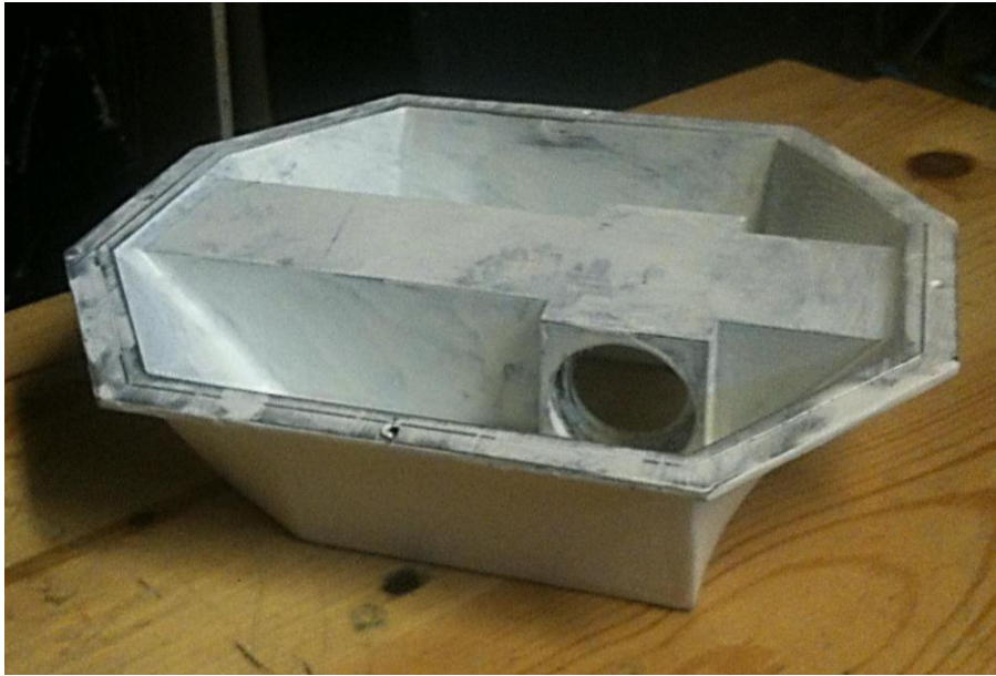
KUVA 1. Epoksimaalilla maalattu pikamallinnettu pohja (Konsta Kilponen 2015)
