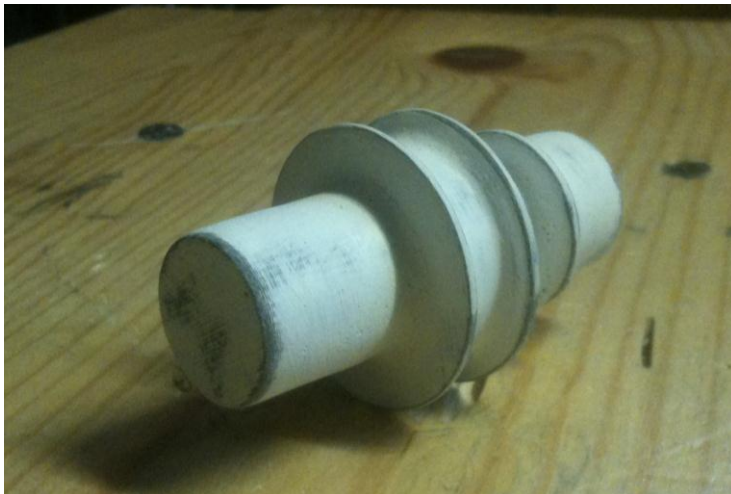
KUVA 4. Epoksimaalilla maalattu pikamallinnettu akseli (Konsta Kilponen 2015)
