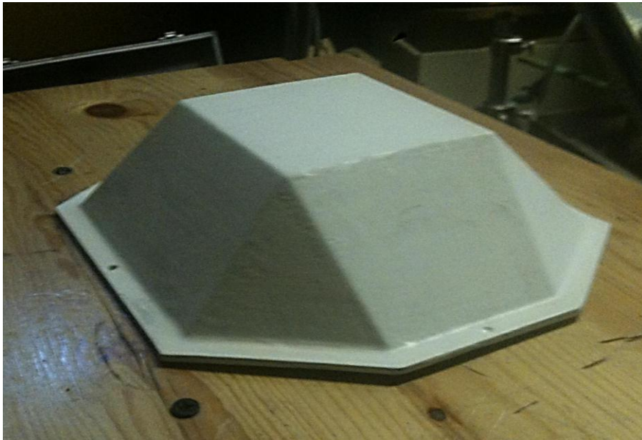
KUVA 3. Epoksimaalilla maalattu pikamallinnettu kansi (Konsta Kilponen 2015)
