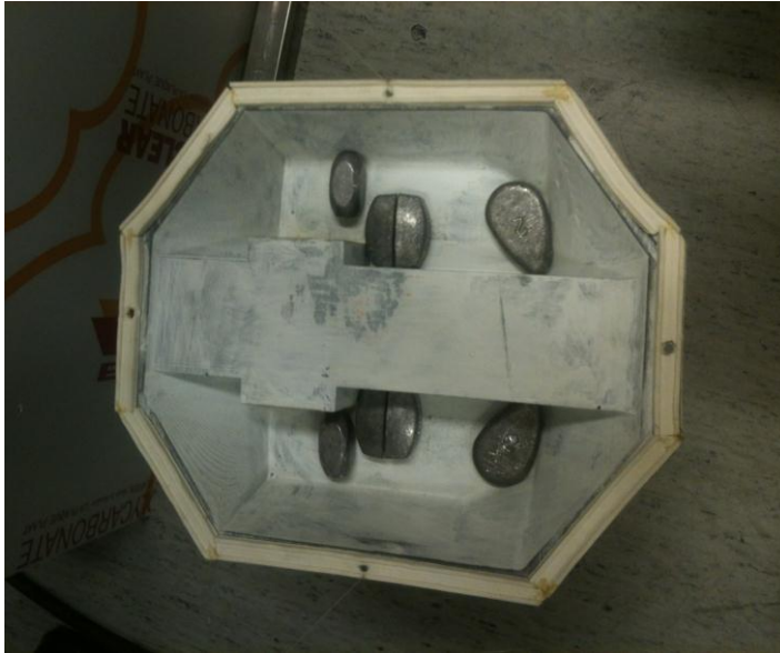
KUVA 13. Tasapainotuslyijypainot kellukan pohjalla (Konsta Kilponen 2015)
