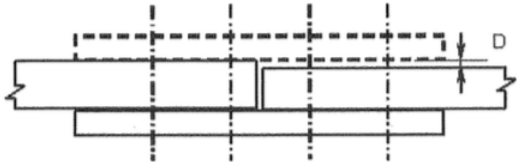
KUVA 1. Samassa tasossa olevien levyosien paksuusero D (SFS-EN 1090-2)
