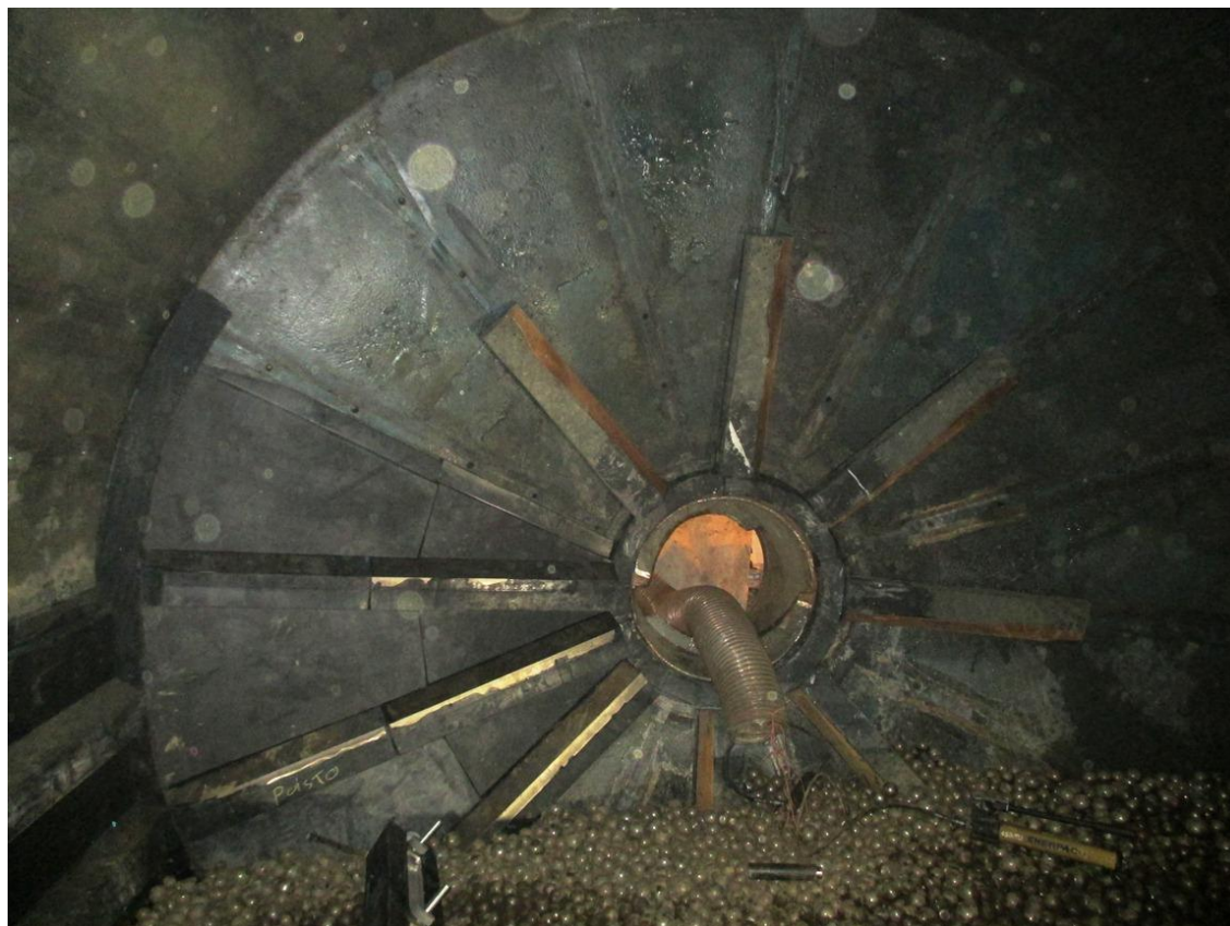
KUVA 5. 1670 myllyn päätyvuorauksen vaihtaminen (Sarvasilta 2014-9-24.)
