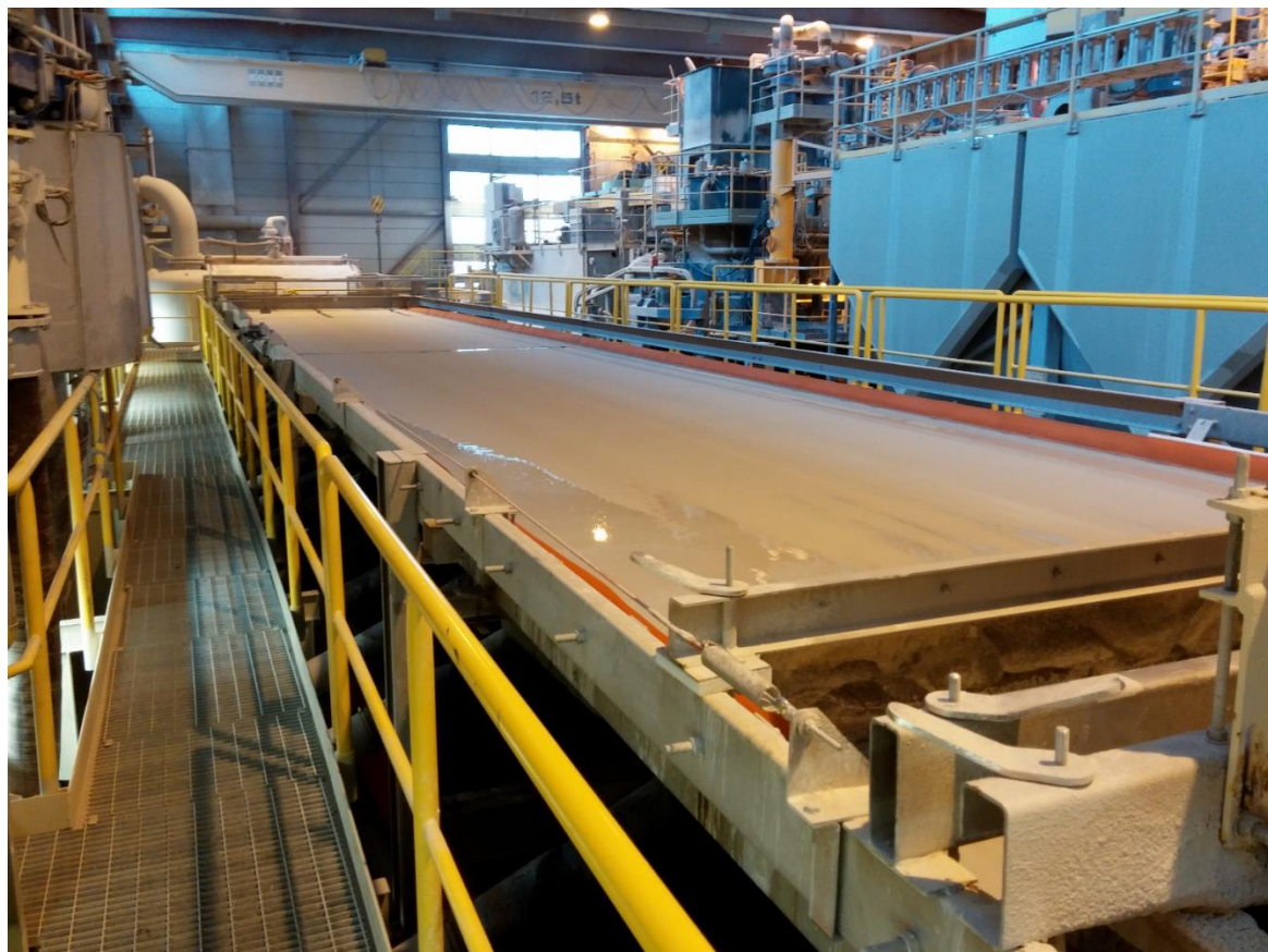
KUVA 1. Nauhasuodin toiminnassa (Kervinen 2015-3-6.)
