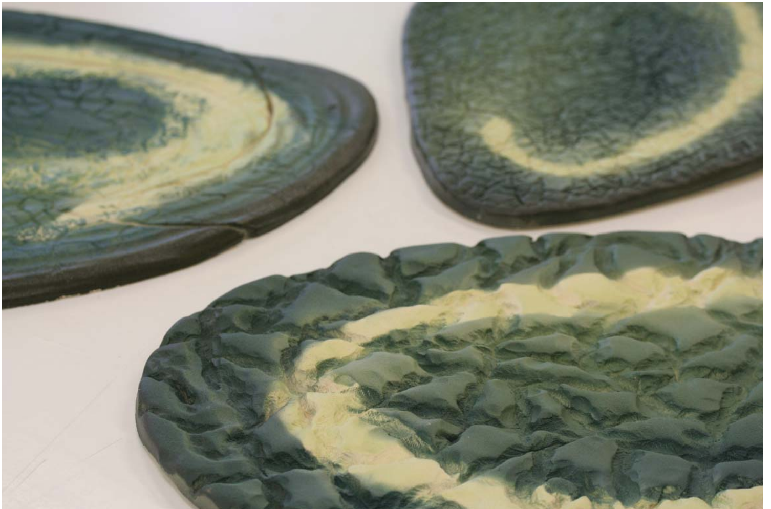
Virvelinrannan resurssikeskuksen julkisivun keraamisia koekappaleita
