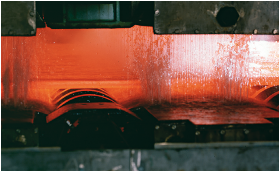
Kuva 2.9 Karkealevyn nopeutettu jäähdytys.
