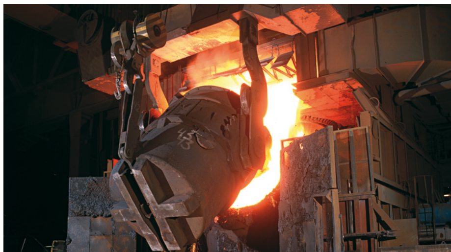
Kuva 2.4 Teräsuuniin lisätään raakarautaa.
