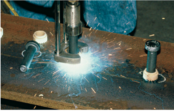
Kuva 14.19 Hitsauspultti. Posliinirengas toimii hitsisulan muottina hitsauksen yhteydessä.
