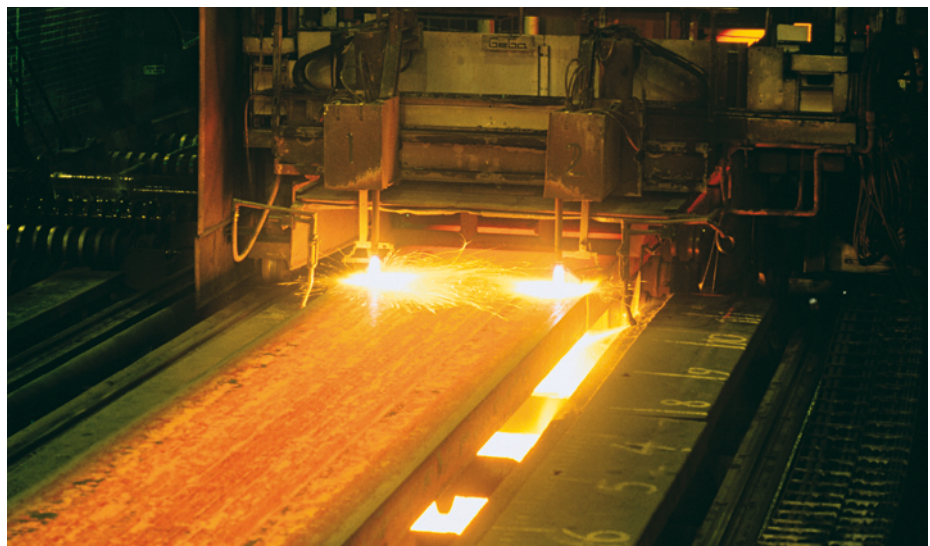
Kuva 2.6 Jatkuvalumenetelmällä valettuja, levytuotteiden valmistukseen tarkoitettuja aihioita.
