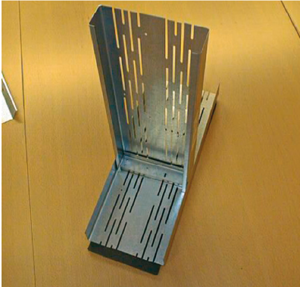
Kuva 6.19 Kylmäsiltoja voidaan vähentää huomattavasti käyttämällä ohuesta materiaalista valmistettua ulkoseinätukea, jonka uuma on rei'itetty. Kuvasta b (ylhäällä) ilmenee, kuinka lämpö kulkee tuessa, jossa on reikiä.
