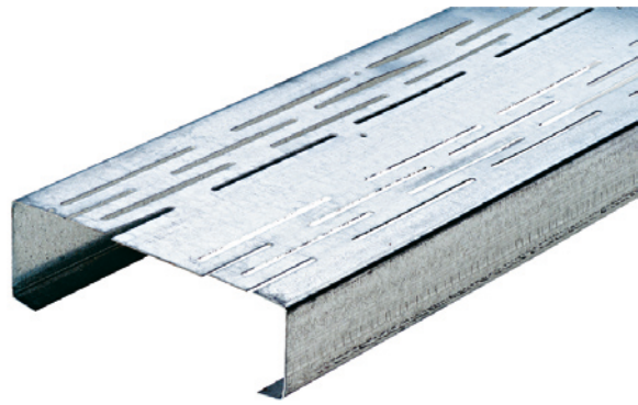
Kuva 13.15 Tuki, jonka uuma on rei'itetty lämmön kulkeutumisen vähentämiseksi.
