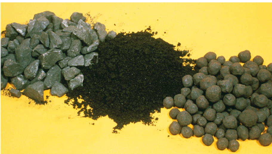
Kuva 2.1 Malmia. Vasemmalta lukien palamalmia, hienoainesta (”mujua”) ja sintrattuja kuulia (pellettejä).
