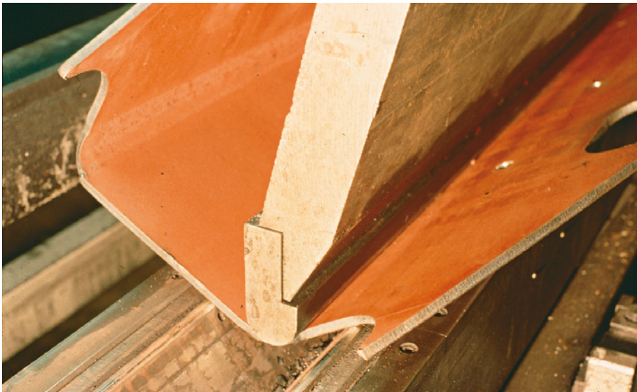
Kuva 9.6 Levyn taivuttaminen särmäyspuristimella.
