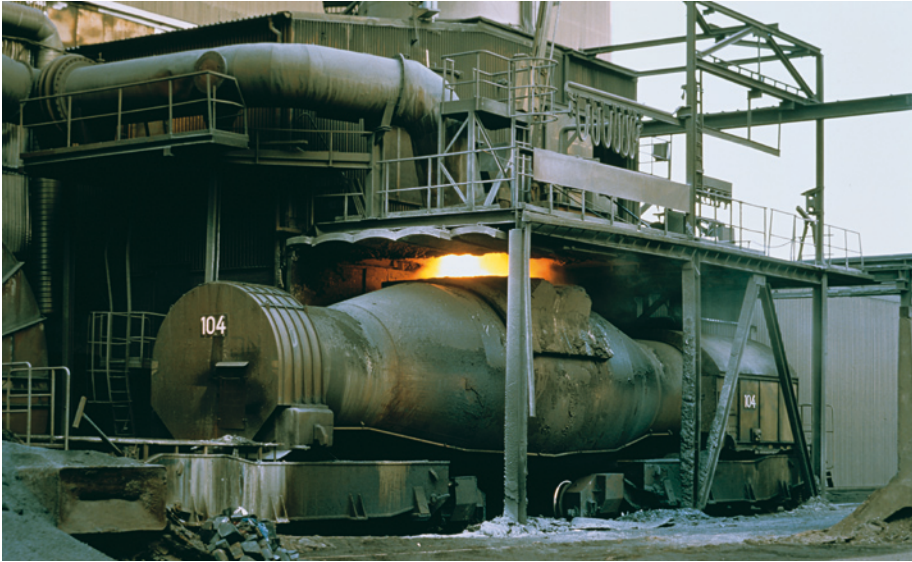
Kuva 2.3 Raakaraudasta poistetaan rikki torpedovaunussa.
