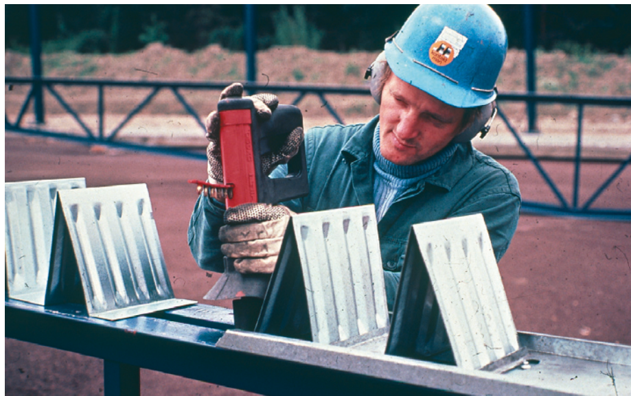
Kuva 13.20 Taittamalla ja puristamalla valmistettuja ohutlevyprofiilin tukilevyjä.
