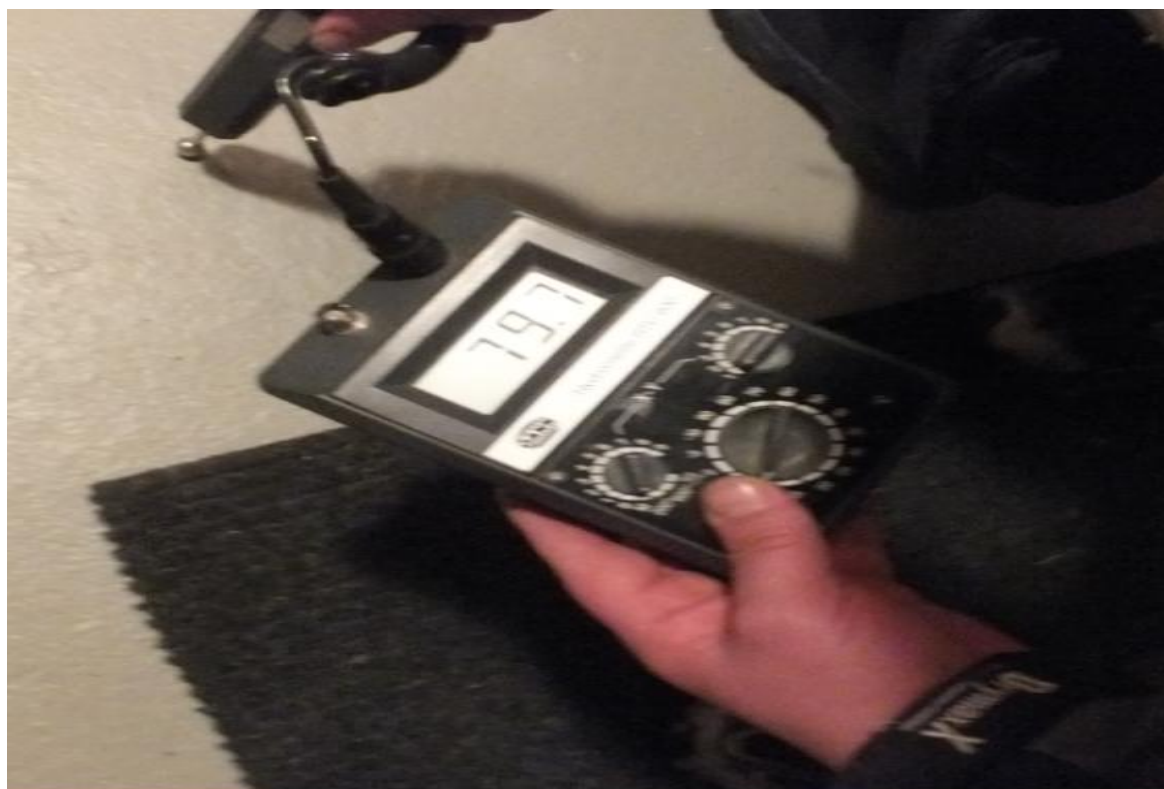
KUVA 5. Kosteusmittaus betonilattiasta (Hartikainen 2014-11-22)
