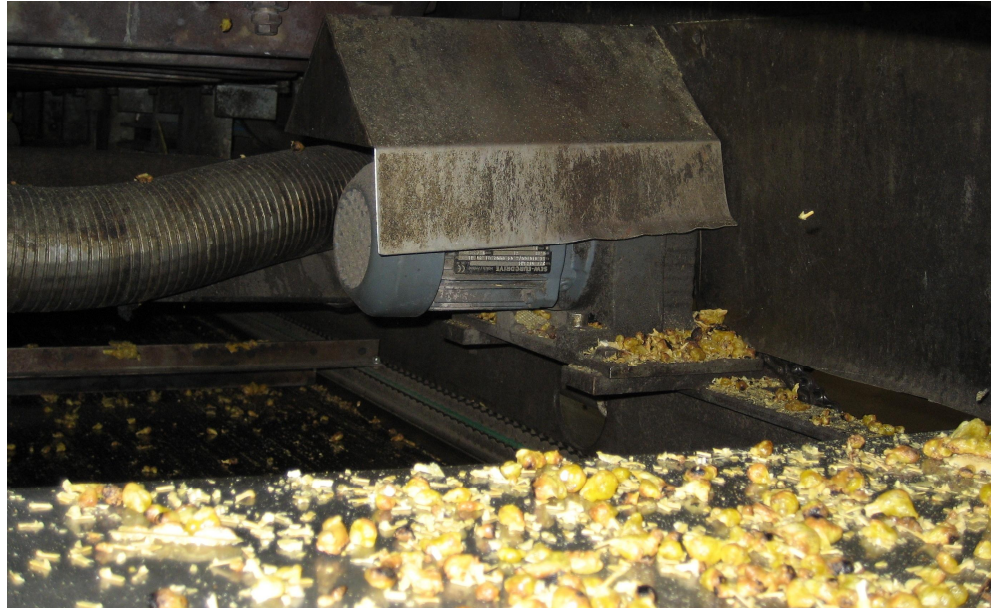
Kuva 21. Kolakuljetin, moottori ja paistojäämiä
