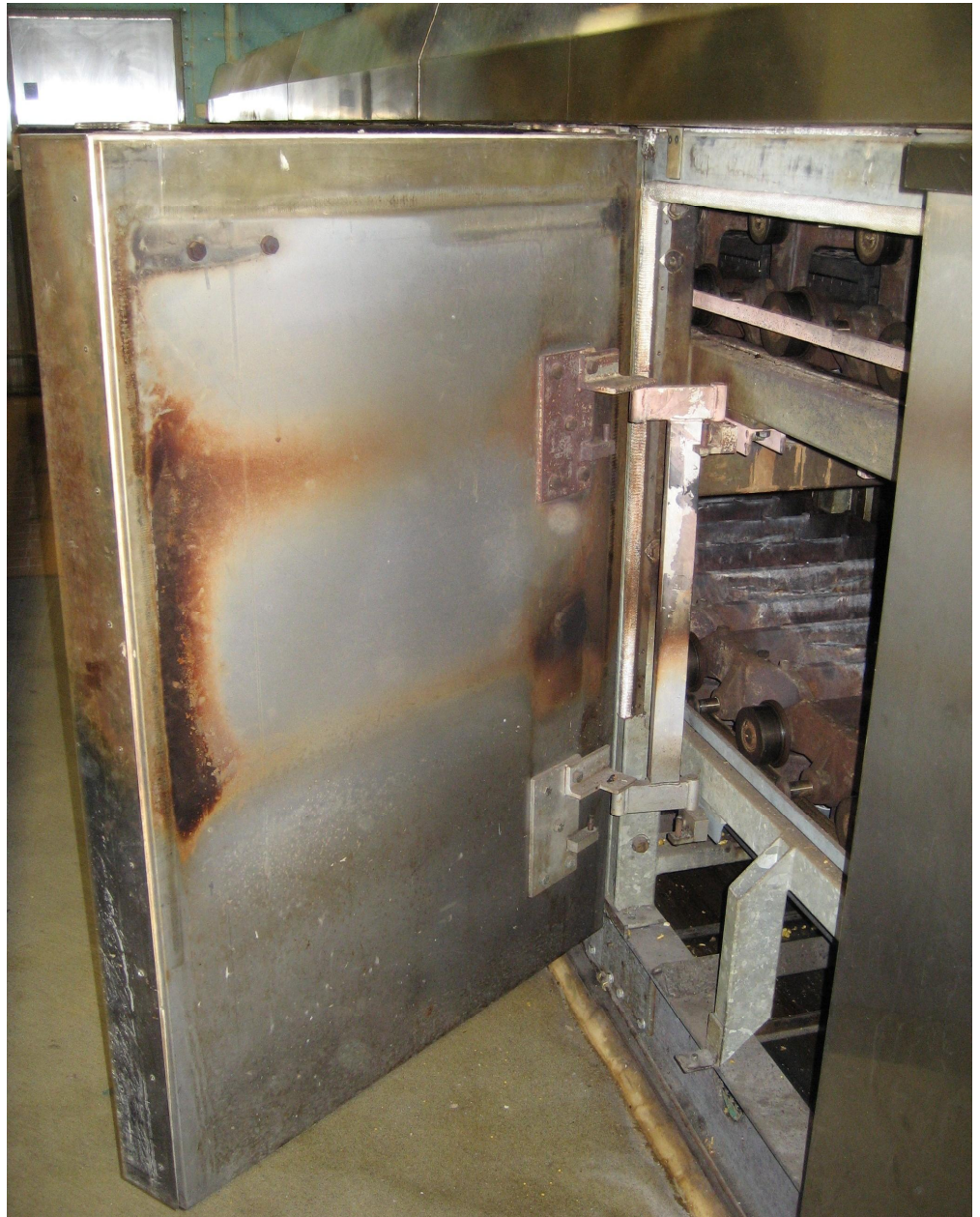
Kuva 22. Ovi ja runkorakenne
