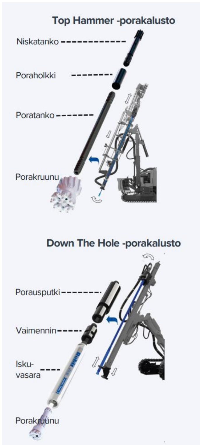
Kuva 1: Ylempänä päältälyövä porakalusto ja alempana uppoporaus kalusto ( https://www.inderes.fi/files/4419fe60-65d1-4c83-b48b-ed09d8714d4f )
