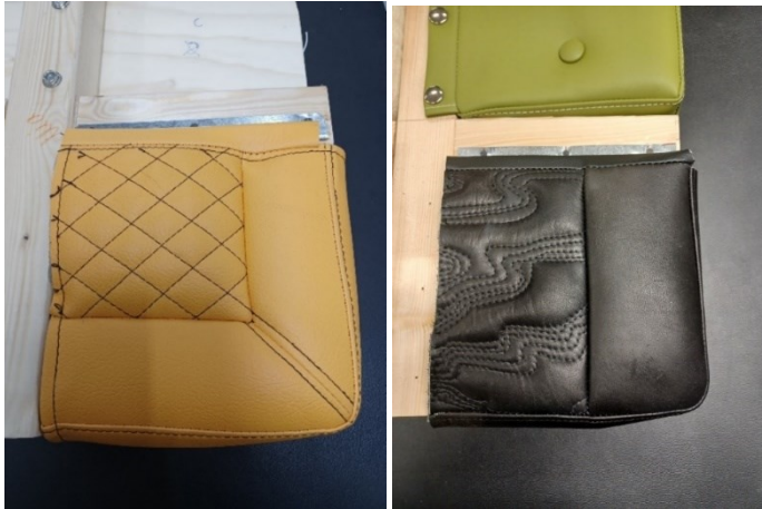
Kuva 65. a) Keinonahkainen auton penkin kulma, b) nahkainen kulman päällinen suoralla sisäänvedolla.
