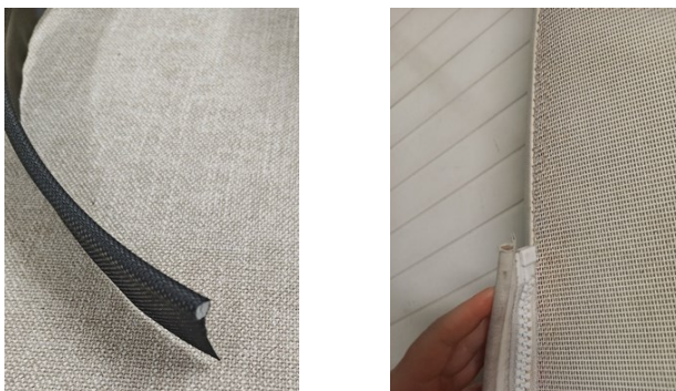
Kuva 20. a) Keder nauha 75 mm, (Sisustus Muovikum Oy) b) veneen kansipatjan vetoketjuun ommeltu kiinnitysnauha.
