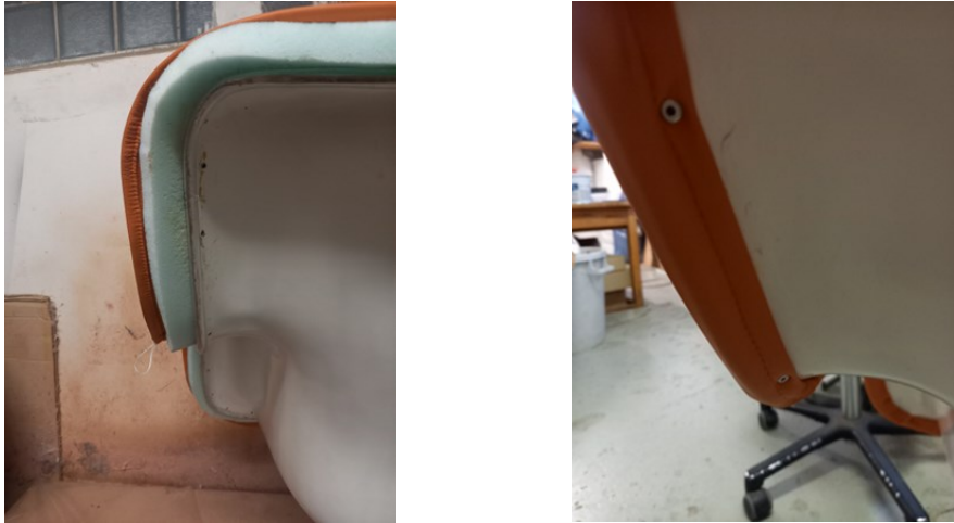
Kuva 24. a) Junior 417-tuolin tekoprosessia, b) pop-niitti kiinnitykset valmiissa tuolissa.
