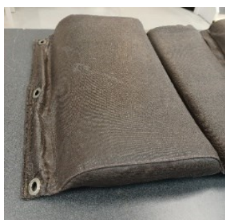
Kuva 31. Soikeat purjerenkaat patjarakenteessa.
