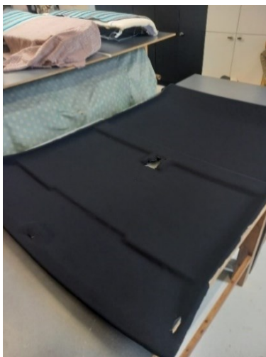
Kuva 13. Kovalevyiseen muotoon puristettuun kattoon liimattu laminaatti.
