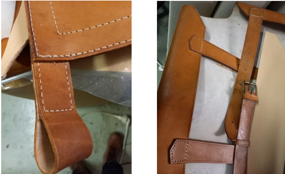
Kuva 15. a) Nahasta valmistetun tuolin päällisen kujakiinnitys, b) ja remmikiinnitykset.
