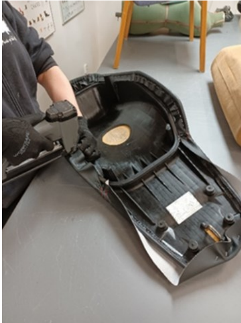
Kuva 10. MP-satulan keinoahan kiinnitys hakasilla.
