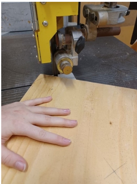
Kuva 55. a) Sahausta vannesahalla, b) kulmien pyöristys mittojen mukaan.
