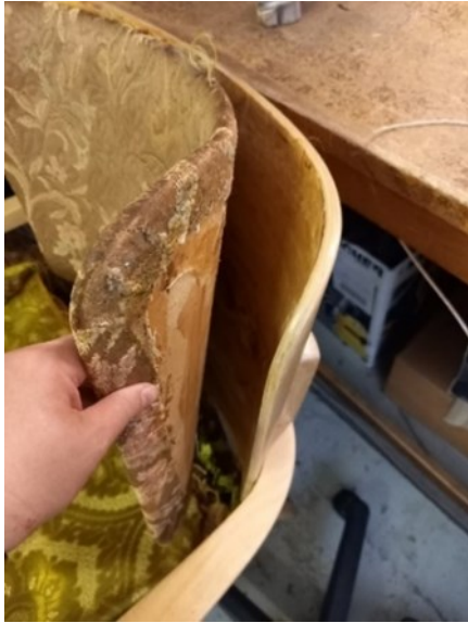
Kuva 12. a) Tuolin etuselän verhoilukankaan kiinnitykset liimaamalla, b) nojatuolin sisäkäsinojan pahvin liimauksia ja pahvin nupinaulauksia.
