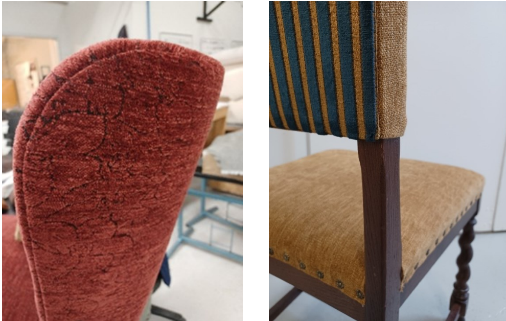
Kuva 11. a) Nojatuolin takaselän kiinnitys piilopistoilla, b) piilopistoja, piilonaula ja koristenauloja uusbarokkituolissa.
