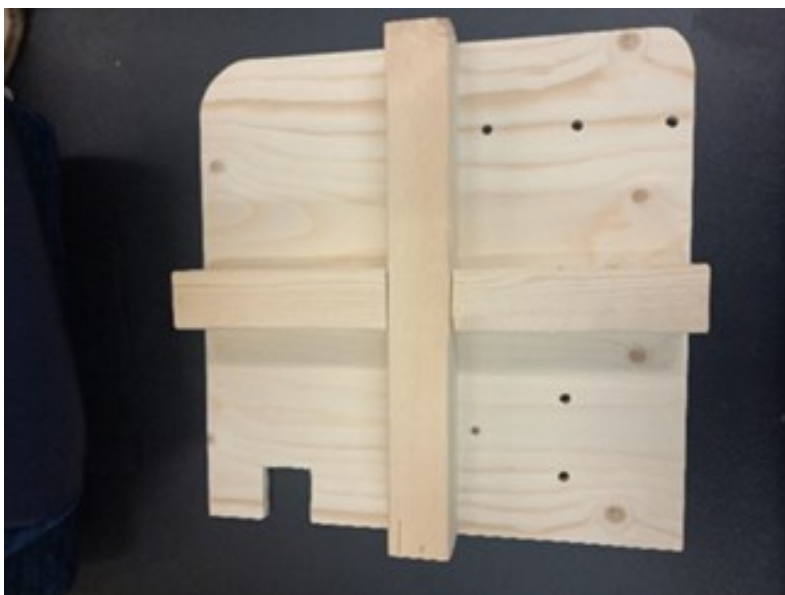
Kuva 51. Opetusapuvälineen runko, jonka kulmiin harjoitellaan erilaisia pehmustus, päällystys ja kiinnitystekniikoita.
