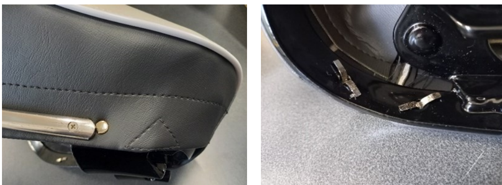
Kuva 25. a) Moottoripyörän satulan ruuvi- ja niittikiinnitys metallirunkoon, b) keinoahan kiinnitys sisäpuolelta.
