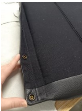
Kuva 27. Experiment-tuolin nepparikiinnitys verhoillussa tyynyrakenteessa.
