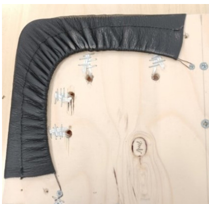
Kuva 66. Pohjassa kuja ja rautalanka, sisäänvedot on kiinnitetty hakasilla.
