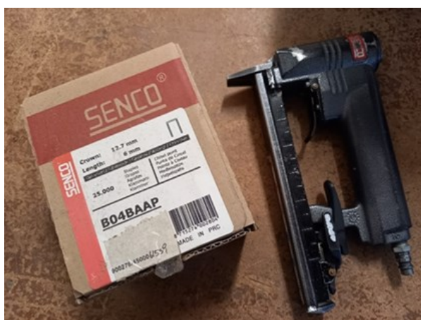
Kuva 6. Verhoilijan käyttämä hakasnaulain ja B-sarjan 6 mm pitkiä hakasia.
