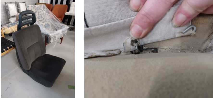
Kuva 44. a) Vanha auton penkki, b) selkänojan sisäänvedon kiinnitys autokoukuilla.
