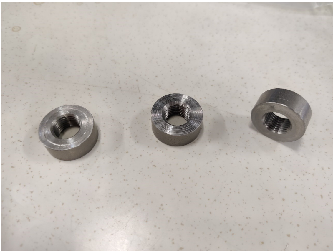
Kuva 17. Adapterit värinämittausantureiden kiinnitykseen (Kuva: Aleksi Timonen).
