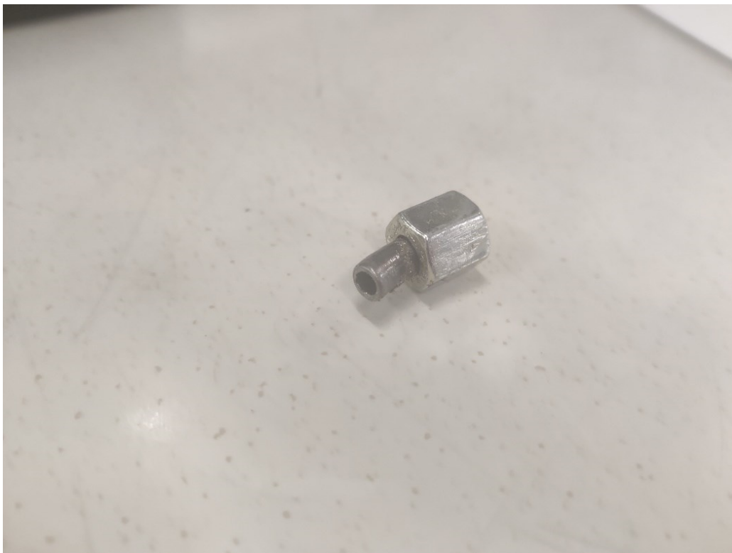
Kuva 15. Ionisoitu paineilma suunnattiin leikkuupisteeseen itsevalmisteisella suuttimella (Kuva: Aleksi Timonen).
