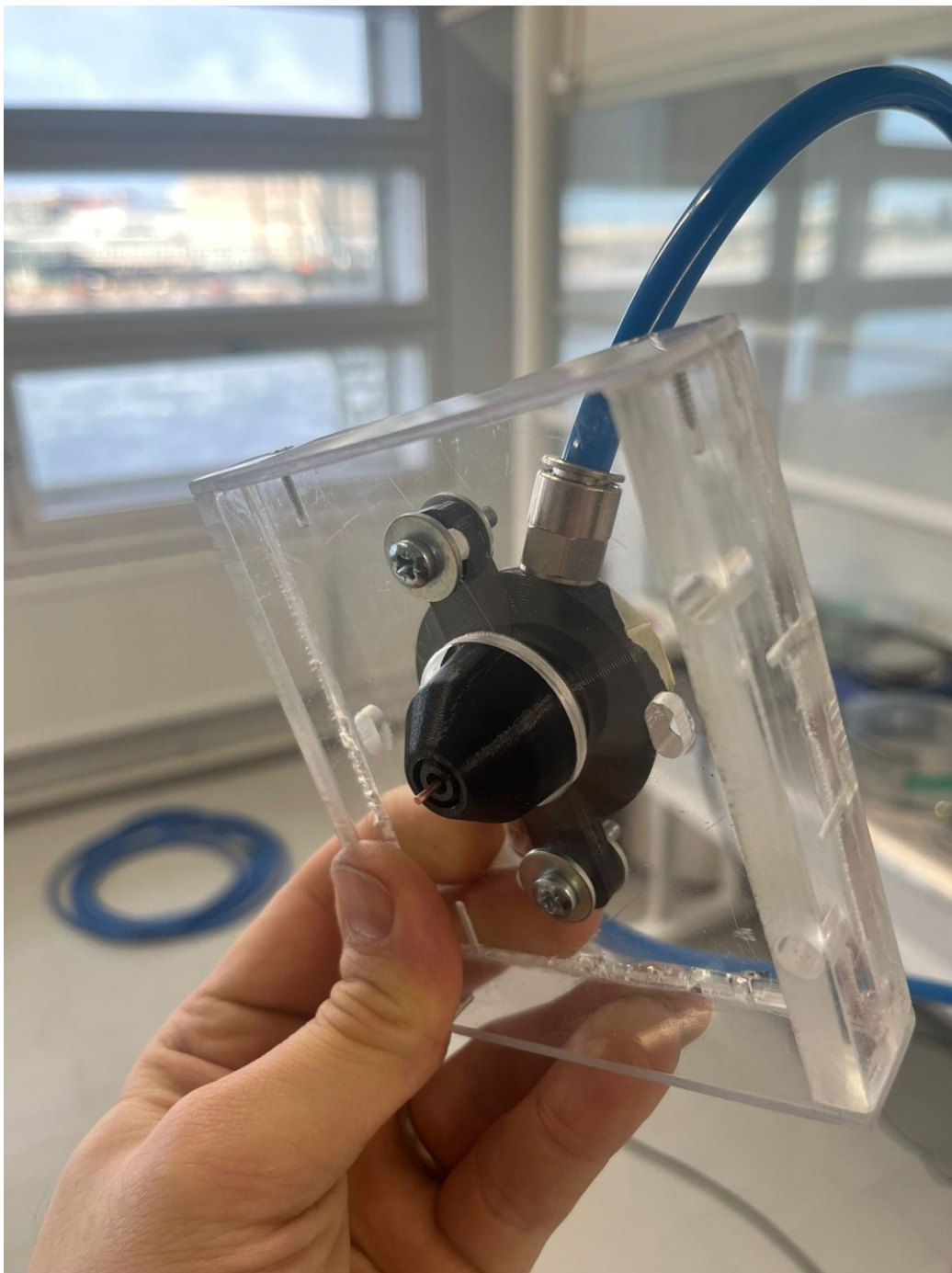
Kuva 16. Erityisvalmisteinen suutin voisi parantaa voitelua prosessissa (Kuva: Aurion Machining Technologies Oy).
