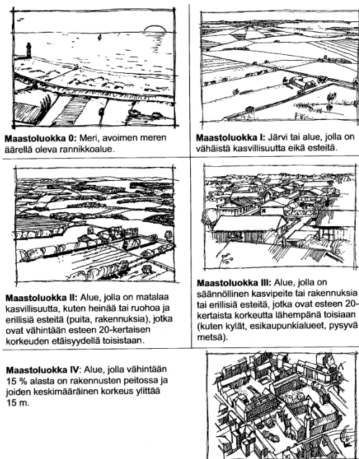
KUVA 2. Maastoluokkien kuvaukset (RIL 201-1-2017, 131)
