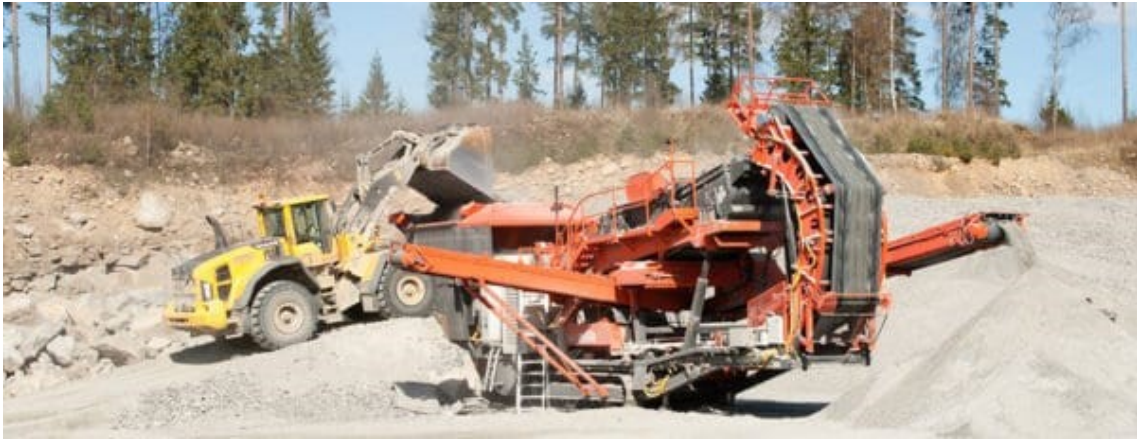
KUVA 2. Tela-alustainen Sandvik UH450 mobiilmurskainyksikkö. (3)
