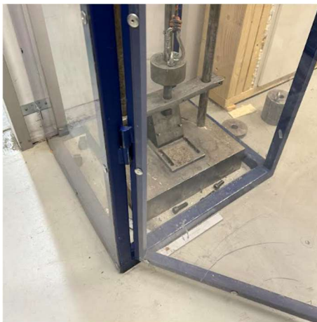
Kuva 17. Iskutestilaitteen ovenavausmekanismi. Creo6 (Kuva: Vesa Väänänen).
