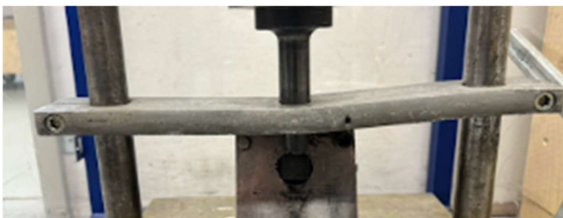
Kuva 15. Nykyisen iskutestilaitteen vaakakappale/kohdistajakappale (Kuva: Vesa Väänänen).
