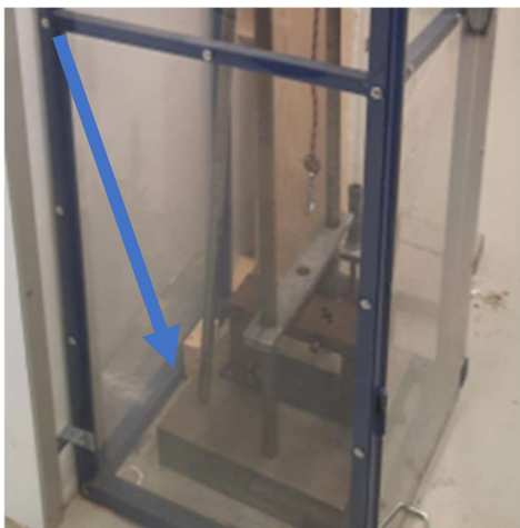
Kuva 11. Nykyisen iskutestilaitteen työskentelytaso (Kuva: Vesa Väänänen).
