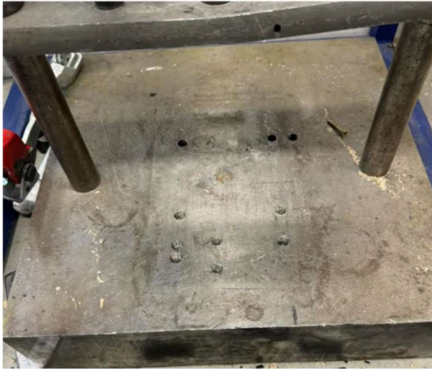
Kuva 13. Nykyisen iskutestilaitteen kappaleen kiinnitys (Kuva: Vesa Väänänen).
