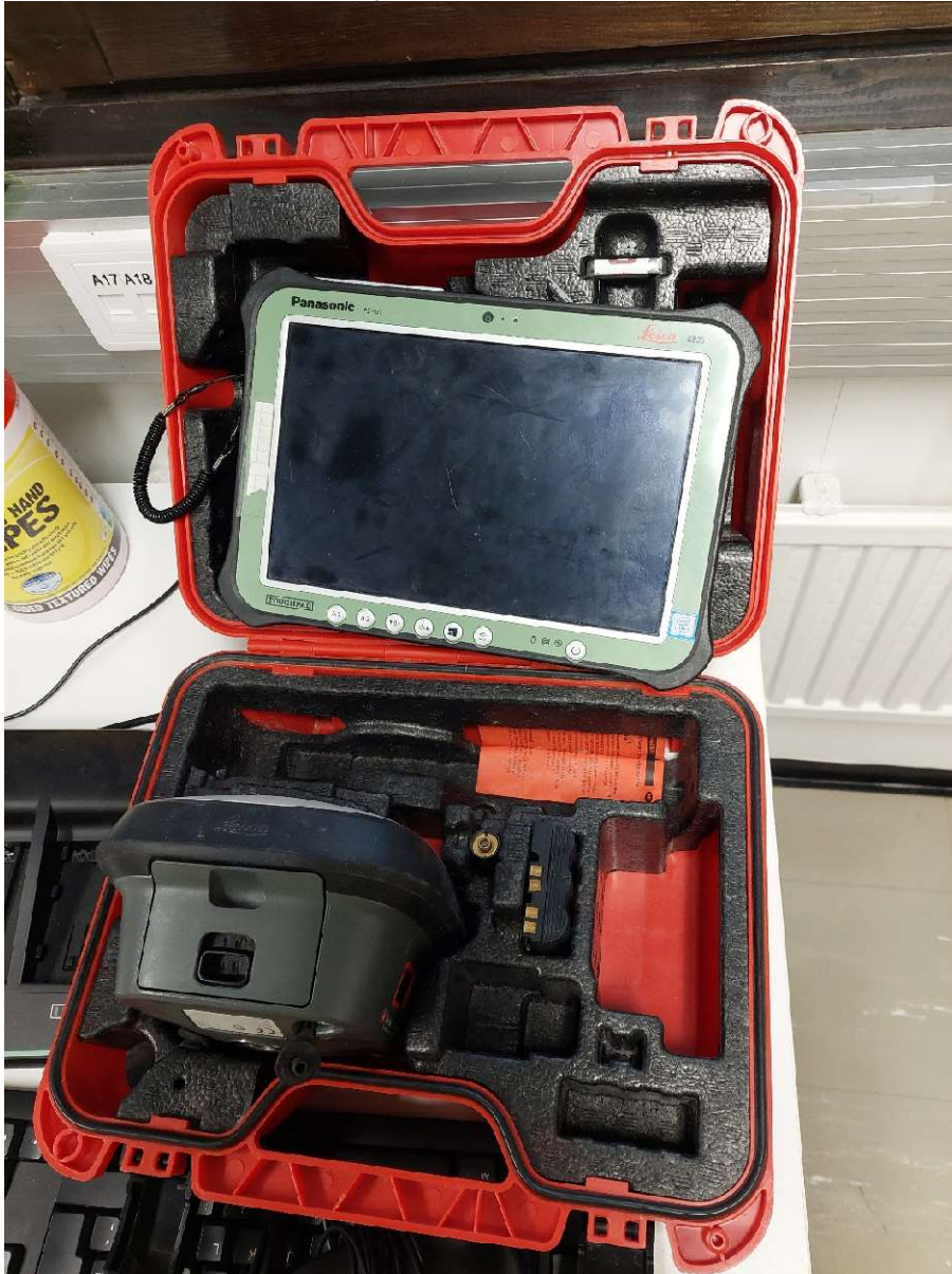
Kuva 13 Salkun sisältö: Paikannin, 2 akkua (toinen paikantimessa) ja lisäantenni. Irtonaisena maastotalennin(padi)
