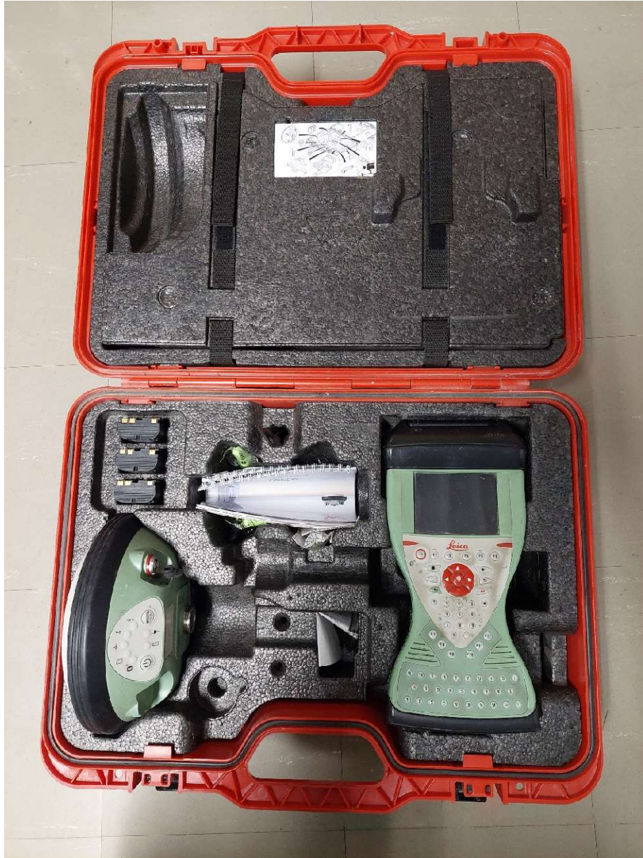
Kuva 10 Salkun sisältö: Sensori, maastotallennin ja akut
