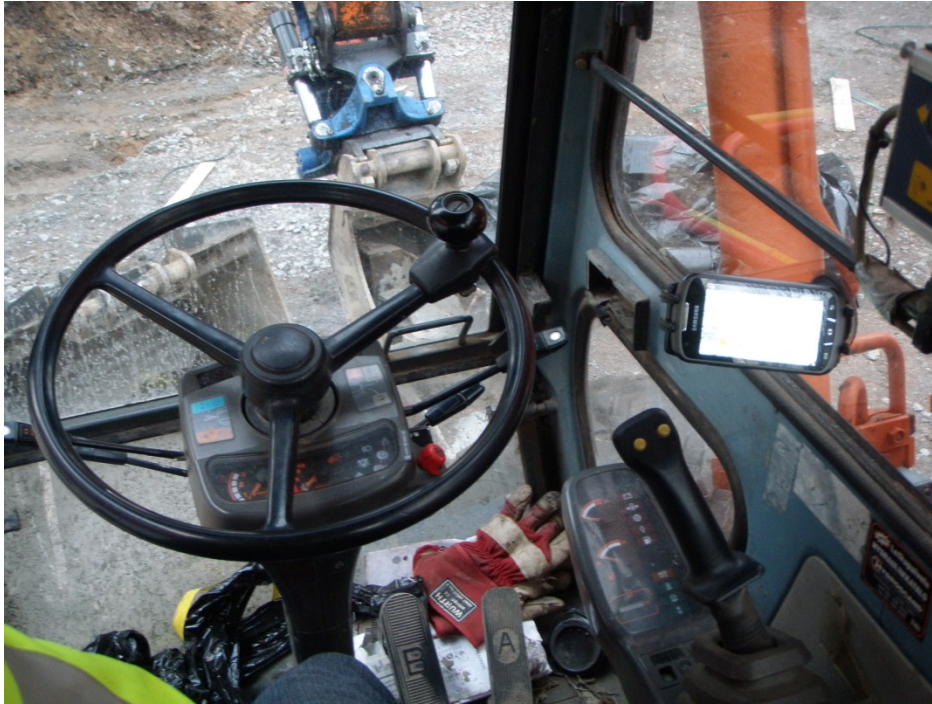
Kuva 4. Kännyksen sijoittuminen kaivinkoneessa.
