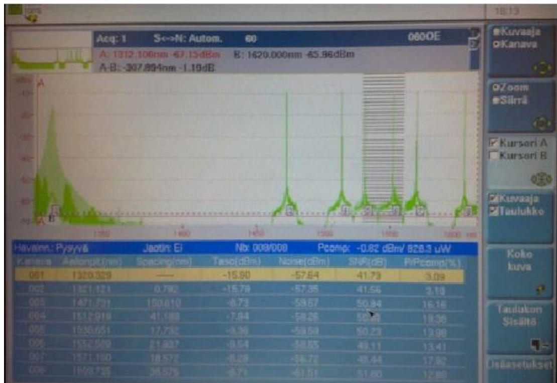
Kuva 11. Mittaustulos Demux:sta ja näkyvissä seitsemän aallonpituutta.
