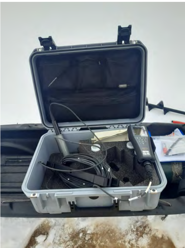
Kuva 25. Ysi Pro ODO -kenttämittari veden happipitoisuuden mittaukseen.
