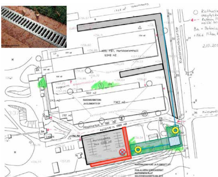
Kuva 8: Kaaviokuva erään nelihenken opiskelijaryhmän hulevesiratkaisuehdotuksesta Rakennusbetoni- ja Elementti Oy:n piha-alueita varten.
