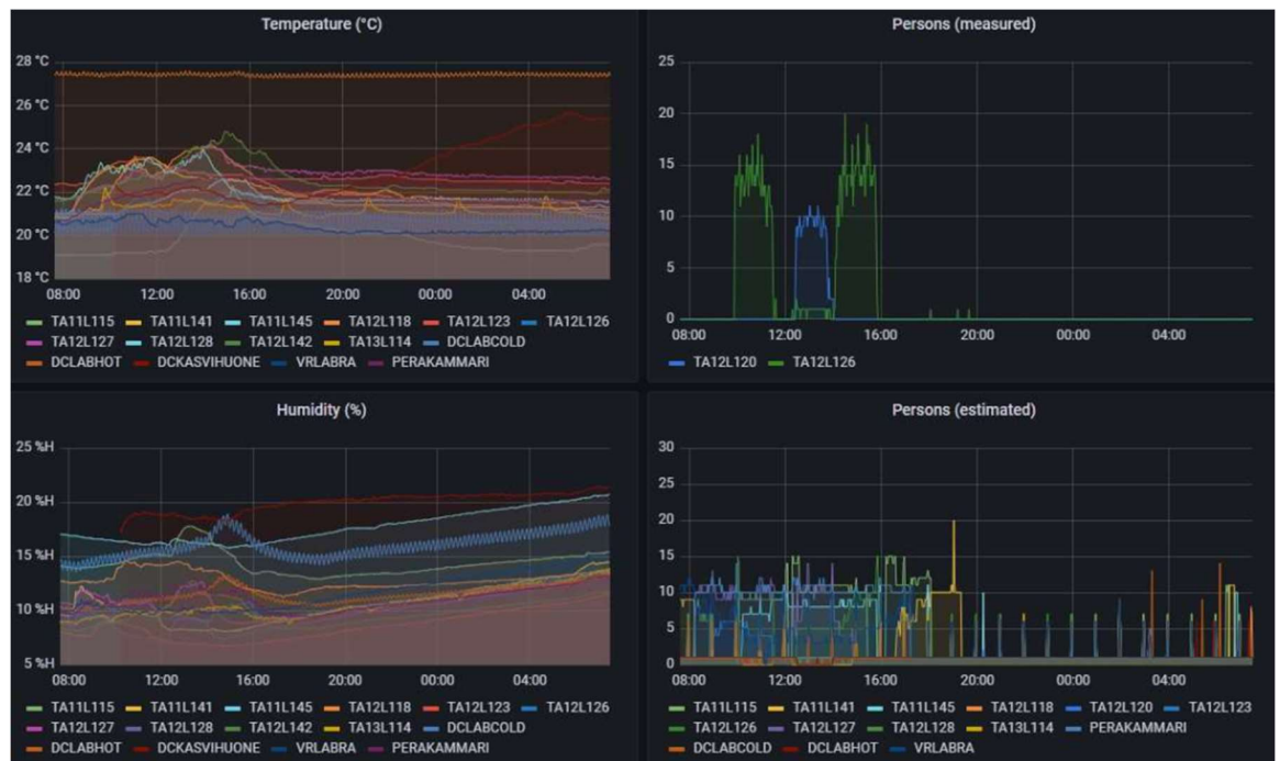
Kuva 12. Grafana-kojelauta, missä näkyy reaaliajassa huoneiden sensoridataa.
