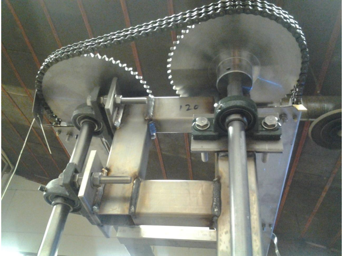
Kuva 3. Hammaspyörät ja kaksirivinen ketju.
