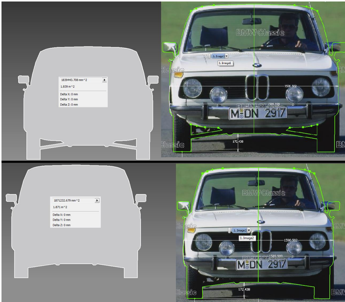
KUVA 16. Esimerkkiajoneuvon otsapinta-alan tutkintamenetelmän havainnollistaminen. (58)
