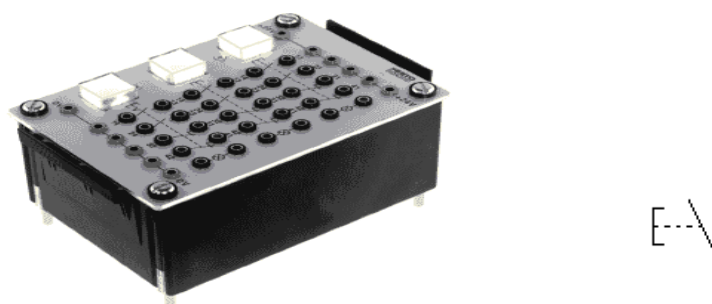
Kuva 6. Painonappikytkinyksikkö ja sen piirrosmerkki [4]
