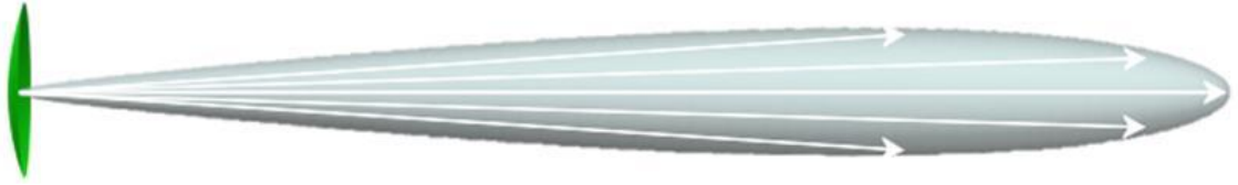
Kuva 7. Antennin peili ja säteilysuunta [5]
