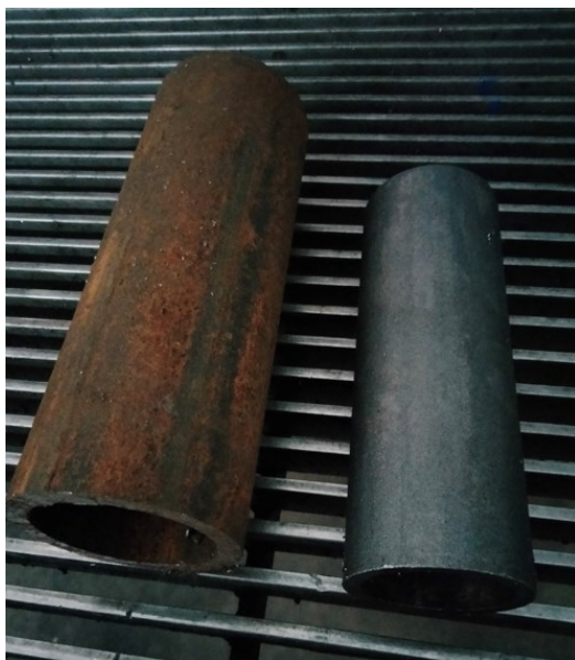
KUVA 2. Putkien pinnat ennen ja jälkeen hiekkapuhalluksen (Backman 2022)
