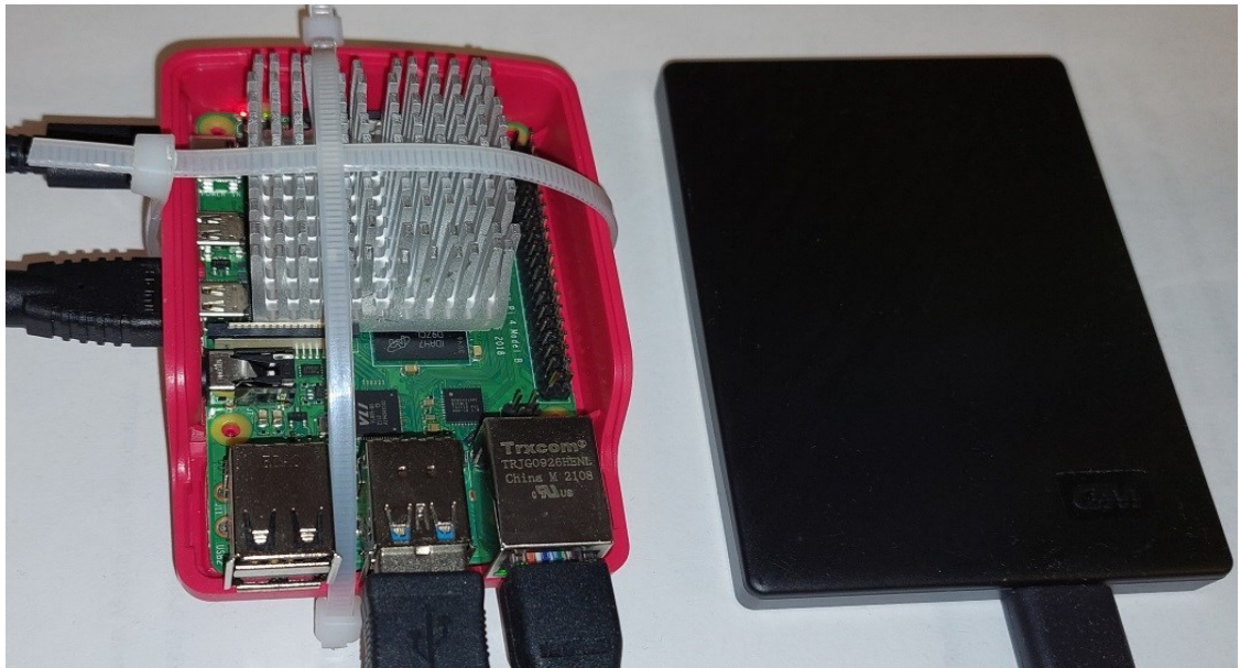
Kuva 4. Raspberry Pi 4B, jossa siili viilennystä varten. Kuvassa myös ulkoinen kiintolevy.
