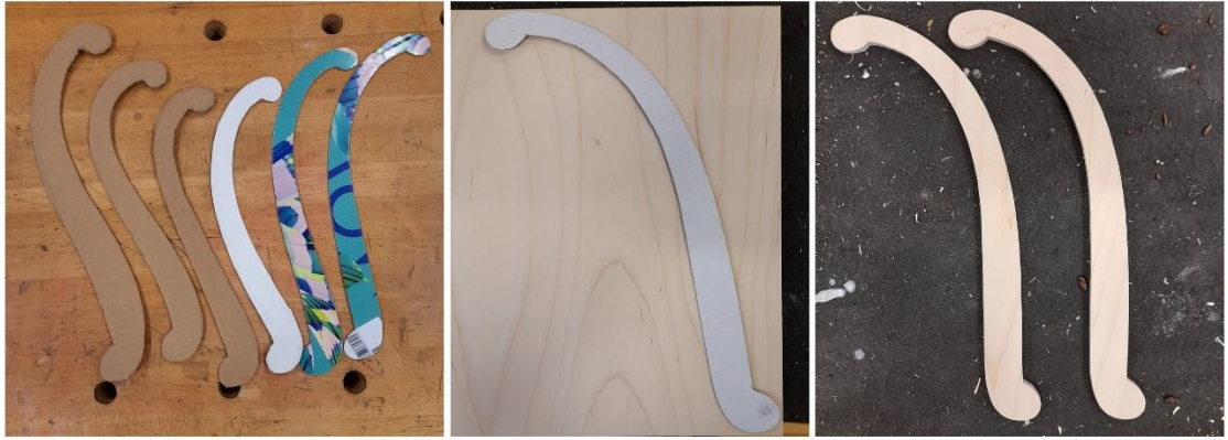
Kuva 14. Prototyyppejä sekä valmiiksi sahatut työntöaisan sivupidikkeet (Henelius 2022)
