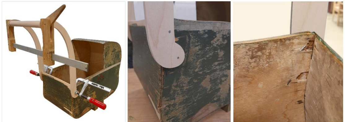
Kuva 15. Työntöaisan kiinnitys nukenvaunujen runkoon (Henelius 2022)
