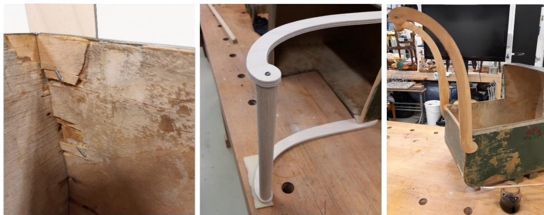
Kuva 16. Työntöaisan kiinnitys ja petsaus (Henelius 2022)
