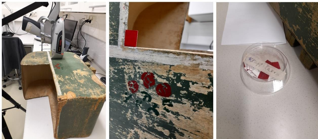
Kuva 5. XRF-mittaus ja punaisen värisävyn vertailu (Henelius 2022)
