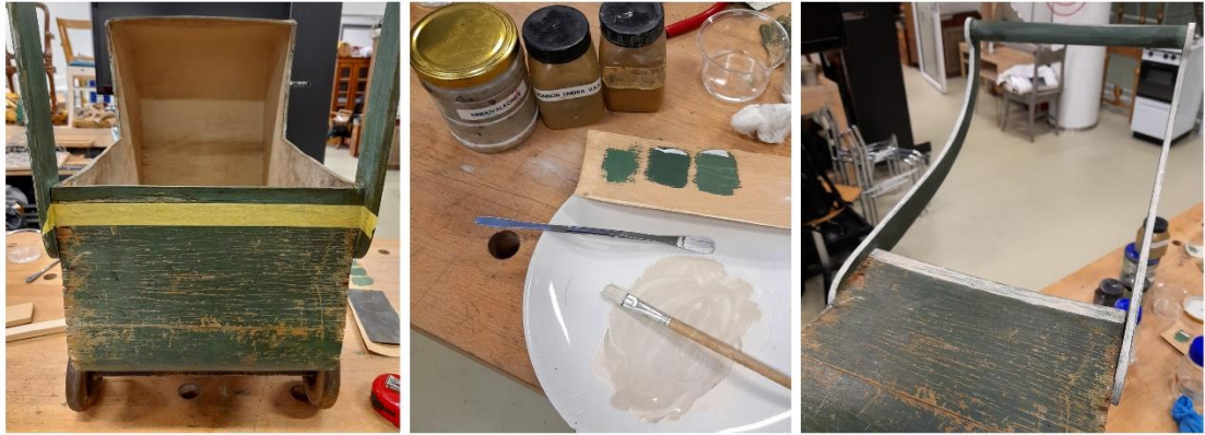
Kuva 19. Suojateippaus, vaalean maalin sekoitus ja maalaus (Henelius 2022)
