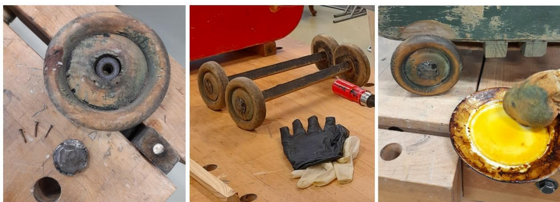
Kuva 17. Pyörien kiristys, kiinnitys ja jälkikäsitely (Henelius 2022)
