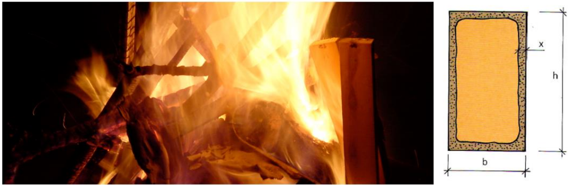
Kuva 26. Puun palaminen ja hiiltyminen. [AK 2014; Siikanen 2008: 166.]
