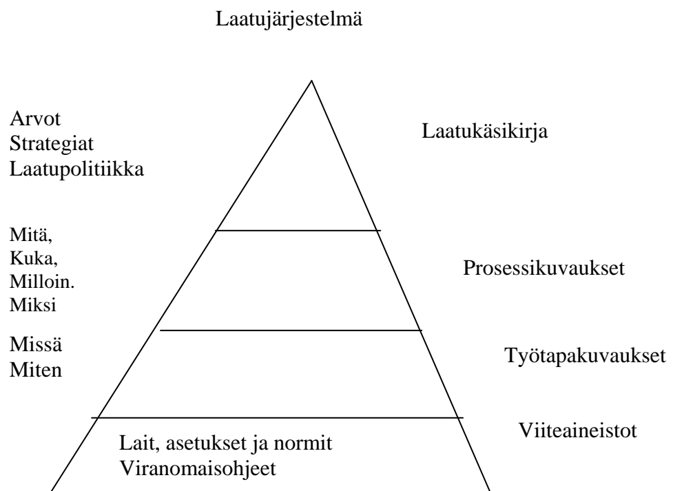
Kuvio 3 Laatujärjestelmän rakenne-esimerkki (Lecklin 1997, 36)
