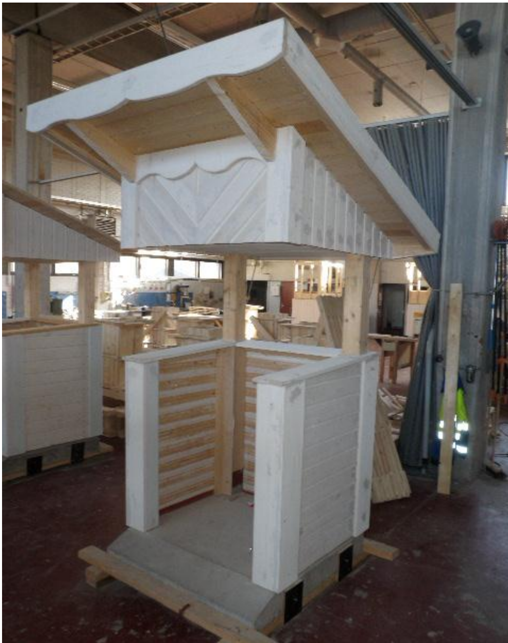
Kuva 13. Jätekatos kiinteällä perustuksella.
