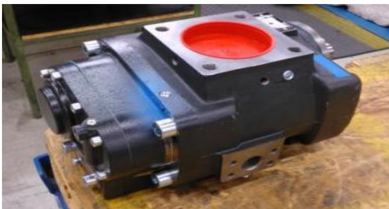
KUVA 6. Koottu yksikkö, johon on asennettu laipat sekä roottorit (Kuva: Tapio Huhtasalo 2013)
