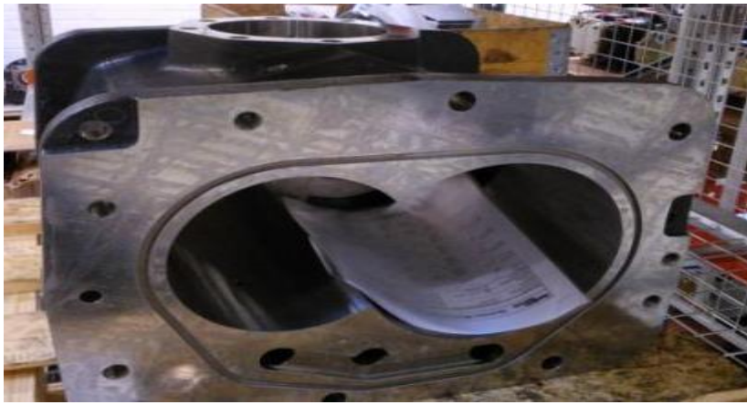
KUVA 5. Ruuviyksikön runko (Kuva: Tapio Huhtasalo 2013)
