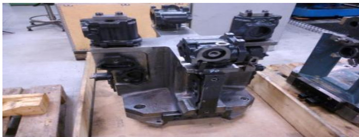
KUVA 3. Paletti/jigiyhdistelmä (Kuva: Tapio Huhtasalo 2013)
