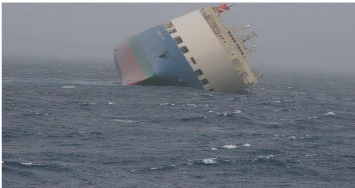
Figur 8. Exempel på misslyckat barlastbyte (Cargolaw 2006)
