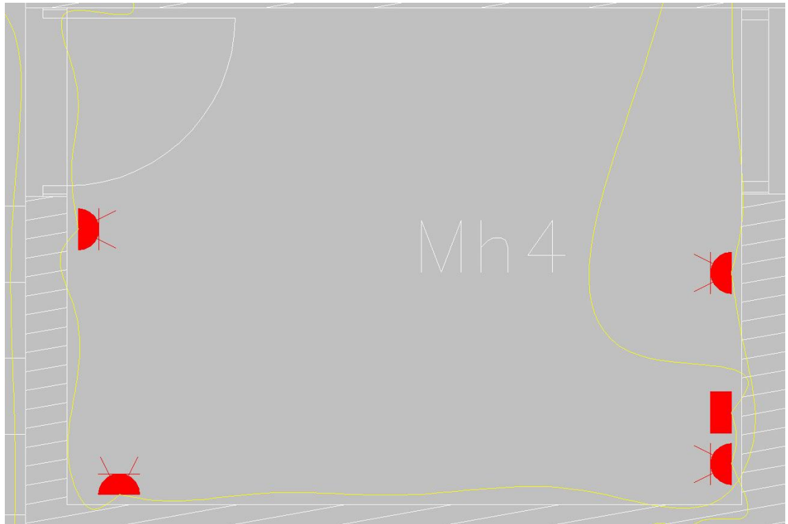
Kuva 5. Osasuurennos kohteen tasopiirustuksesta; kuvaan on jätetty vain huoneeseen asennettavien pistorasioiden sijainnit johdotuksineen, ja muut tasot on piilotettu näkyvistä
