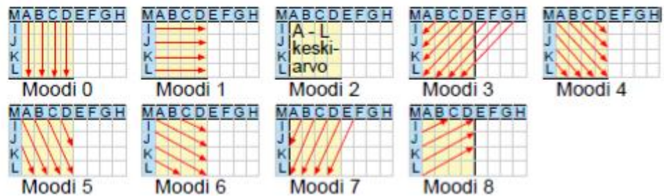
Kuva 9. Intra_4x4-ennustamisen eri tavat luminanssilohkole. Keltainen kuvaa ennustettavaa lohkoa ja sininen on viereisten lohkojen arvot. [7, s. 20.]
