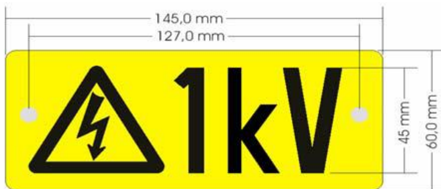
Kuva 8 1 kV kilpi katkaisijakaapin oveen, erotuskytkimeen sekä muuntamoille
