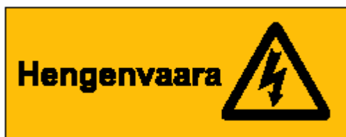
Kuva 6 pylväaseen kiinnitettävä hengenvaarakilpi
