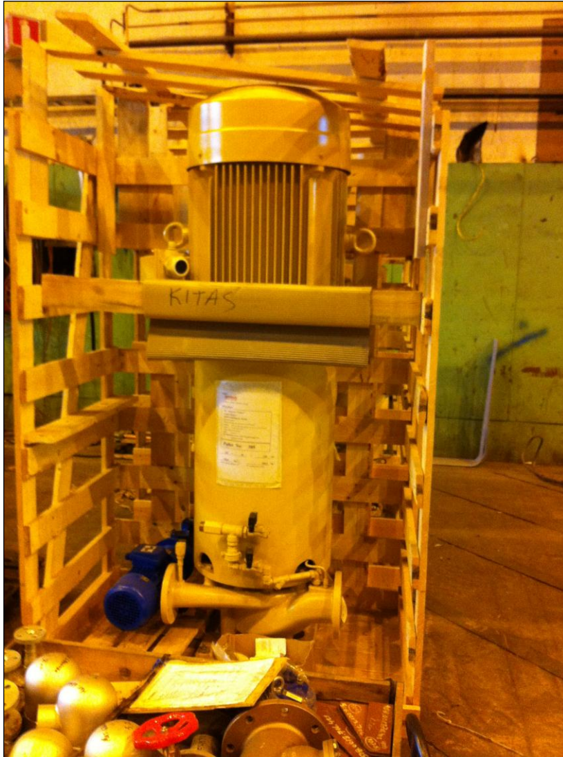
KUVA 15: Palo- ja kannenpesupumppu
