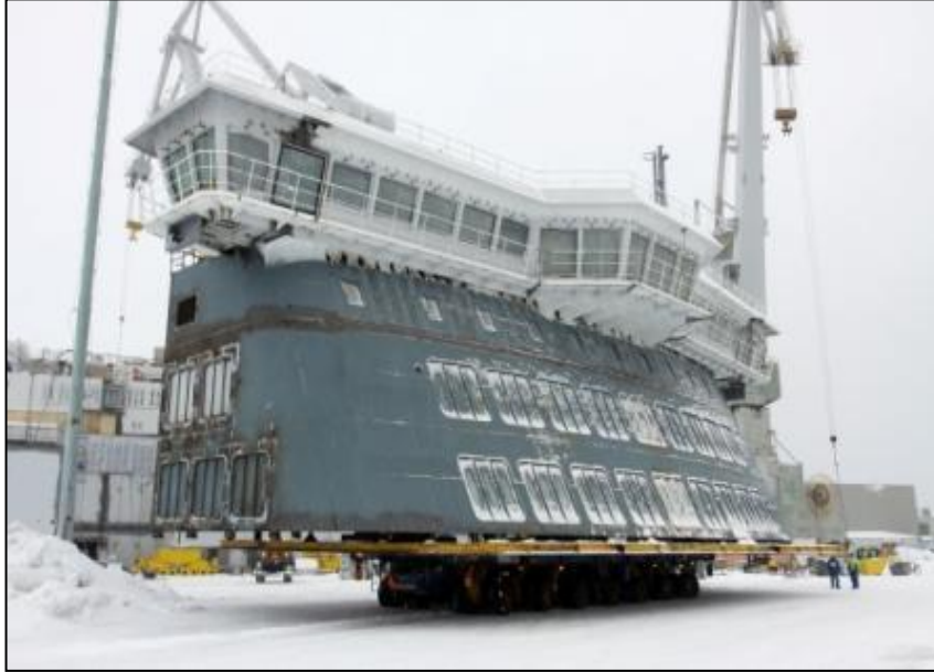
KUVA 3: Valmista lohkoa nostetaan runkoon kiinni yhteenhitausta varten (4)
