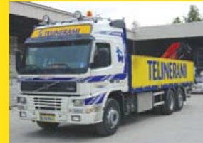
Nosturilla varustettu "nuppi" kuorma-auto. Nuppiin mahtuu n. 7 lavametriä tavaraa.
