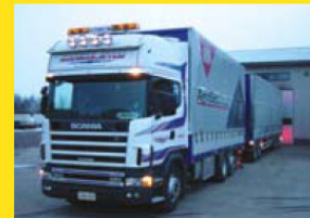
Täysperävaunuyhdistelmä johon mahtuu n. 21 lavametriä tavaraa.
