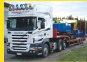
Ajorampeilla varustettu puoliperävaunu. Puoliperävaunuun mahtuu n. 13 lavametriä tavaraa.
