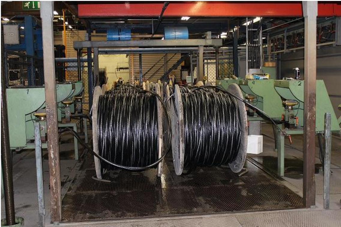
Kuva 17. Riippukierrekaapelit valmiina vesikoestukseen.
