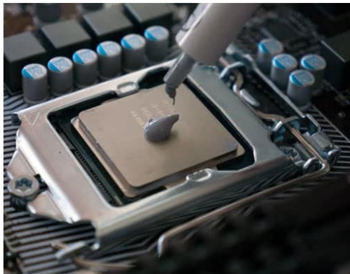
Kuva 7. Lämpötahnaa levitetään prosessorille
