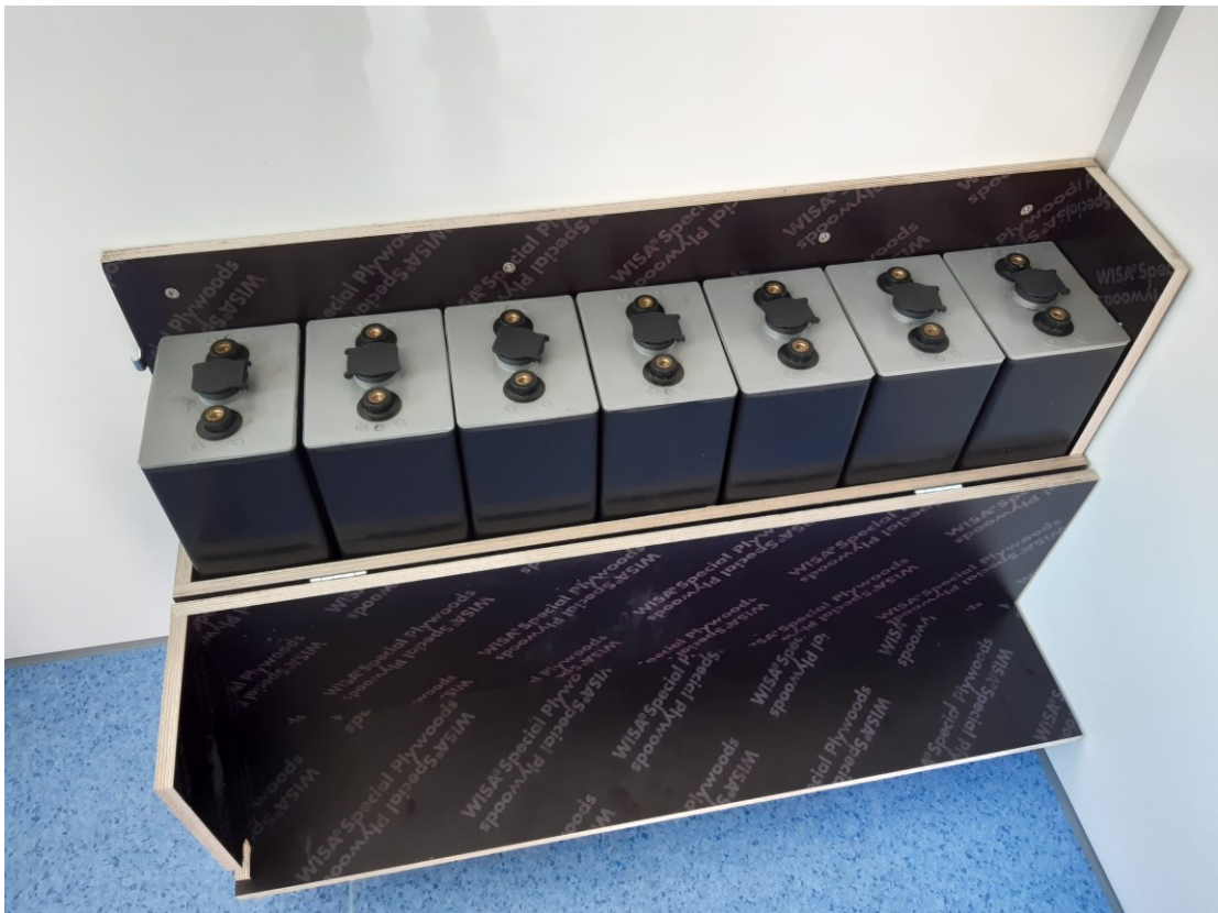
Kuva 14. Akkukennoille rakennettu laatikko, sen saranointi ja 7 kennon akusto (Kuva: Tuomas Hirvonen).
