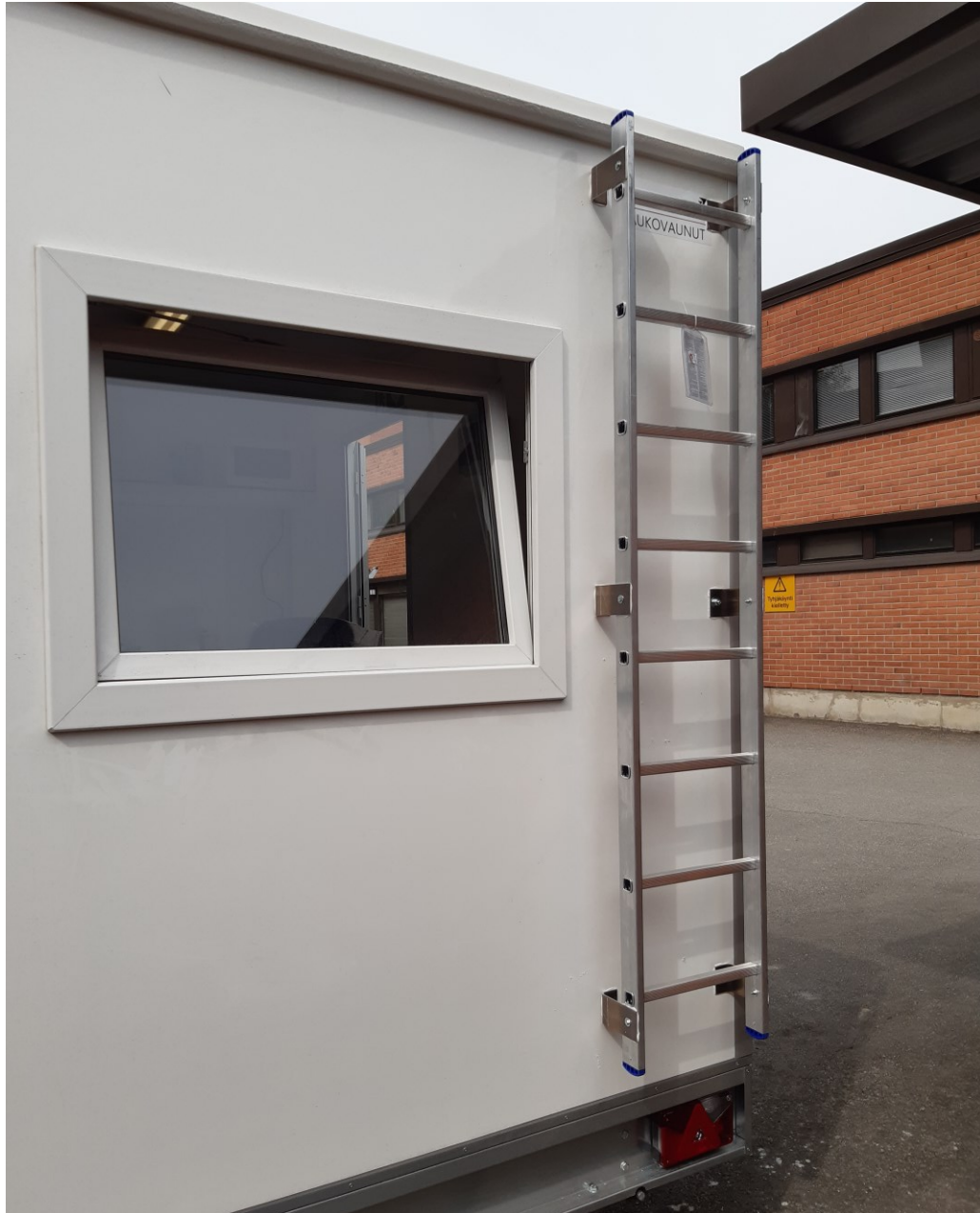
Kuva 11. Vaunun katolla tapahtuvaa kevyttä huoltoa varten kiinnitetyt tikkaat (Kuva: Tuomas Hirvonen).
