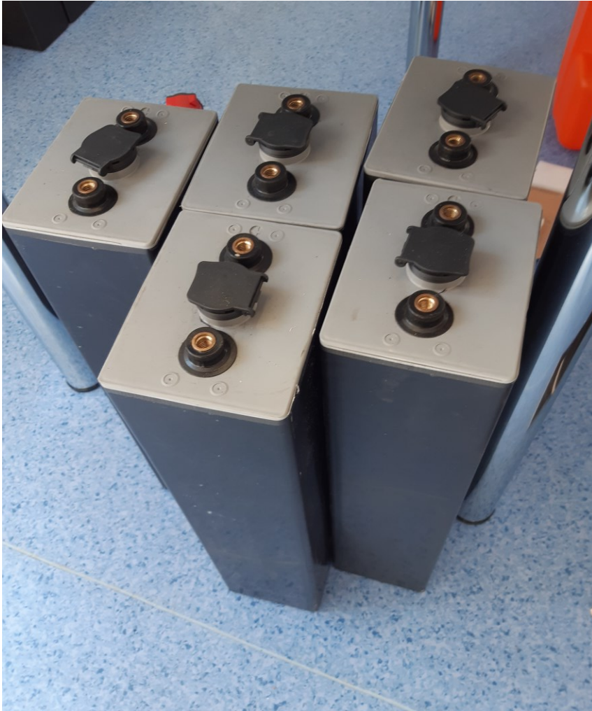
Kuva 13. Teollisuuskäyttöön suunniteltuja akkukennoja vaunun sisälle siirrettynä (Kuva: Tuomas Hirvonen).
