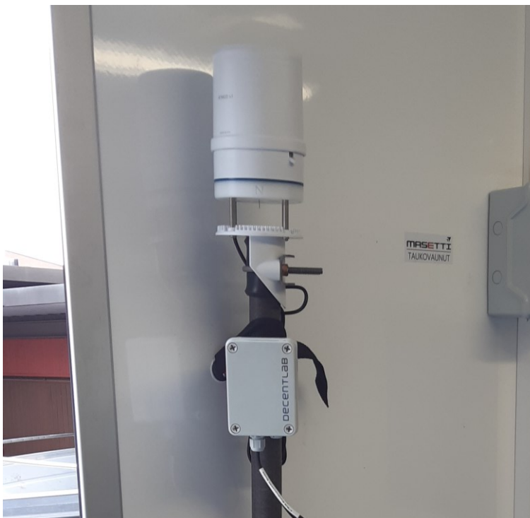
Kuva 1. Decentlab:in valmistama 11 parametrin DL-ATM41 sääasema (Kuva: Tuomas Hirvonen).
