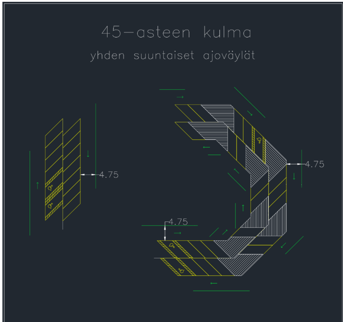
Kuvio 31. Pysäköintiruudut 45 asteen kulmassa. Yksisuuntaisen ajoväylän leveys on 4,75 metriä. Ajosuunnat on vaihdettu sekä päätyalueet poistettu näkyviltä.
