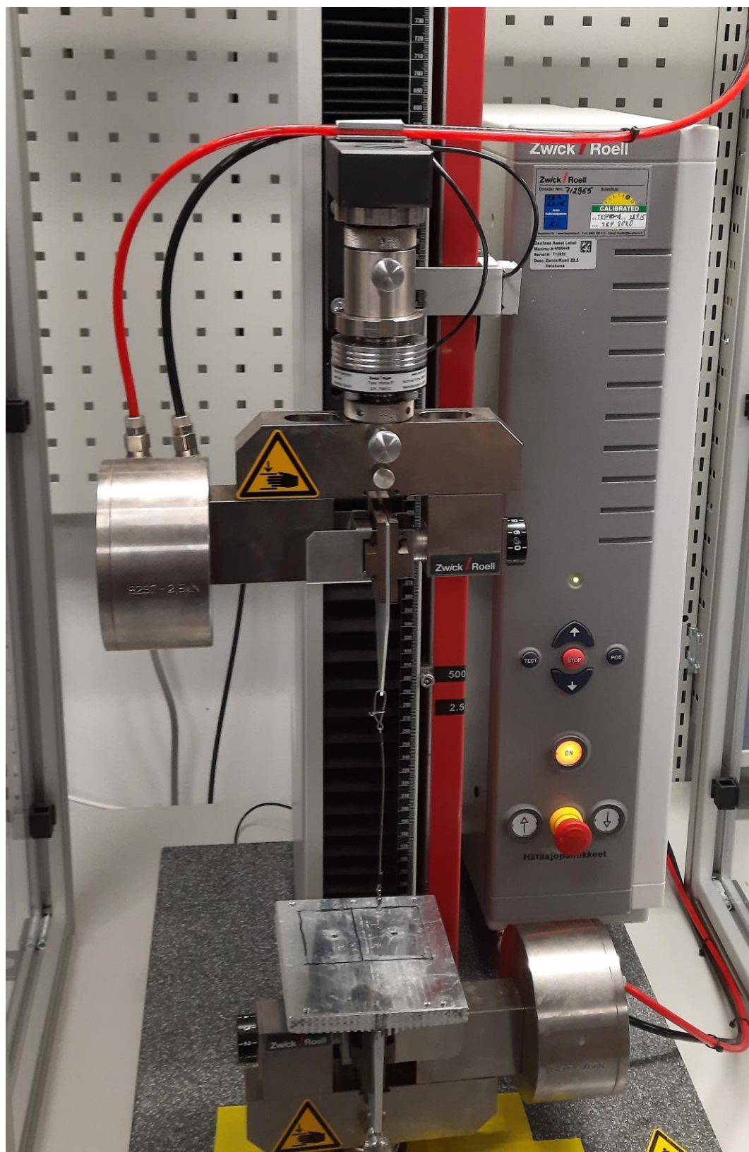
Kuva 13. Vetokone Zwick Roell Z2.5, jolla tehty testit liittoslangoille. 25
