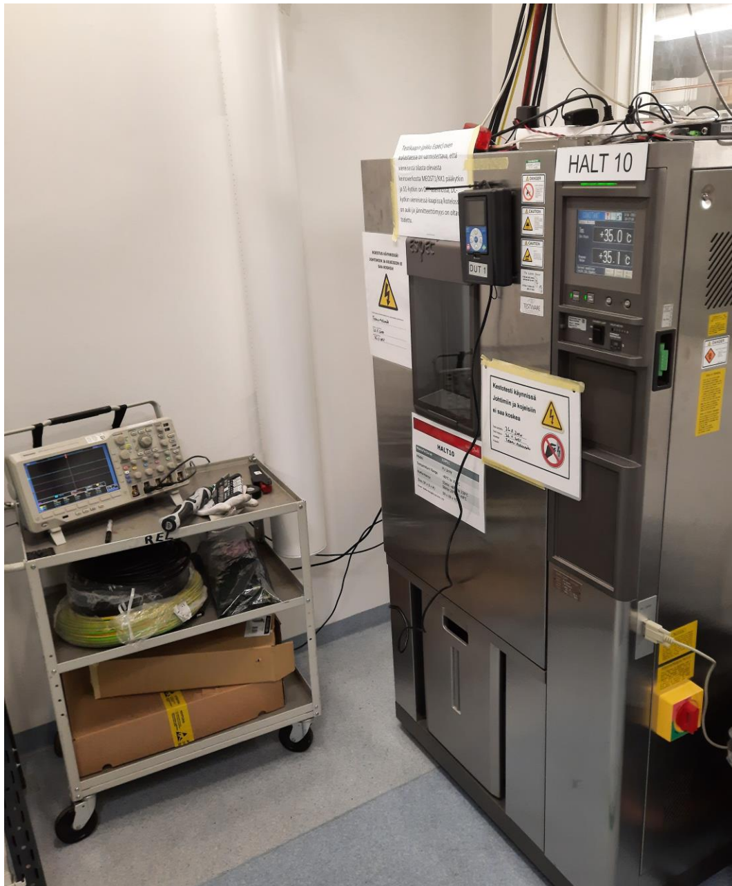
Kuva 8. Testissä oleva laite olosuhdekaapissa. 20
